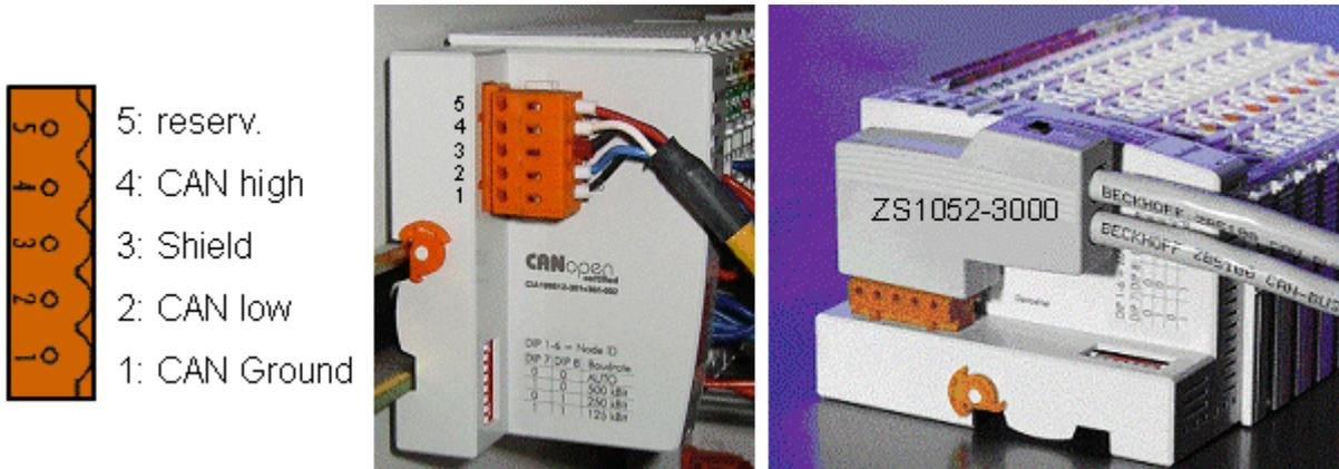
Abb. 25: Belegung Verbindungsbuchse BK51x0/BX5100
