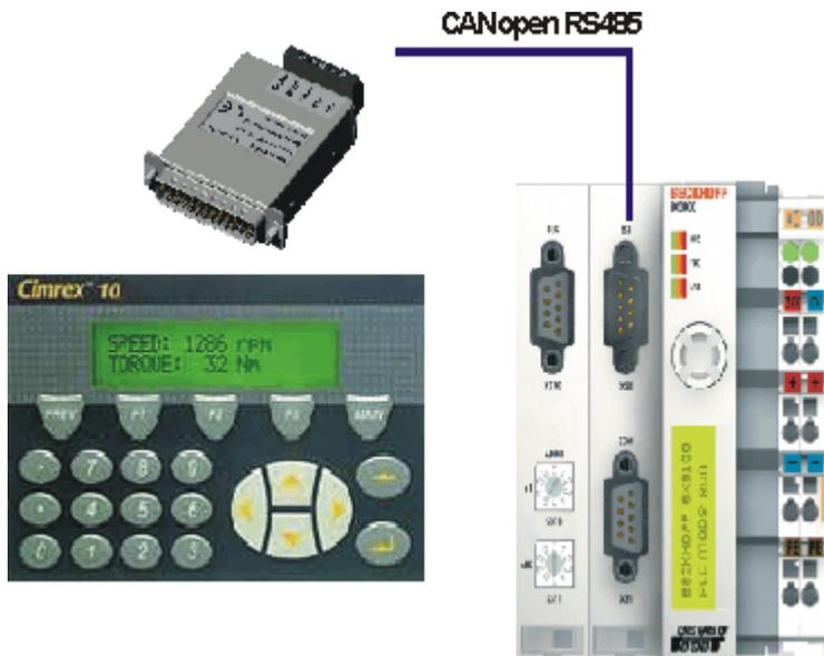
Abb. 63: Cimrex-Panel am SSB des BX-Controllers
