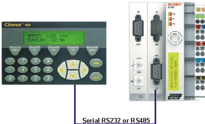
Abb. 108: Cimrex-Panel am COM-Port des BX-Controllers
