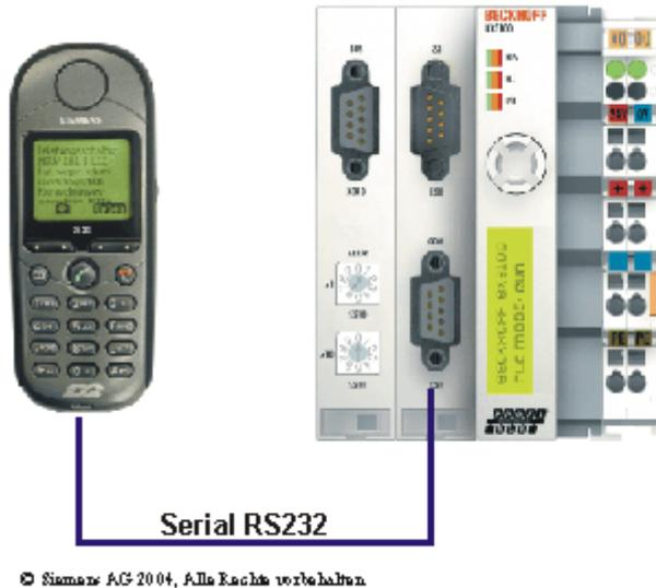
Abb. 109: Mobiltelefon am COM-Port des BX-Controllers
