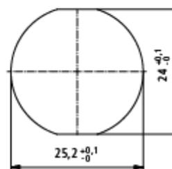
min. wall thickness 1 mm/
