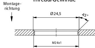
min. wall thickness 1.5 mm/
