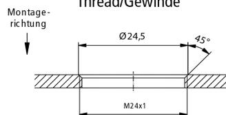
min. wall thickness 1.5 mm/
