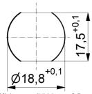
Minimum wall thickness 2,5 mm, alternativ panel cut out d=18,8 / Minimale Wandstärke 2,5 mm, alternativ Frontplattenausschnitt d=18,8
