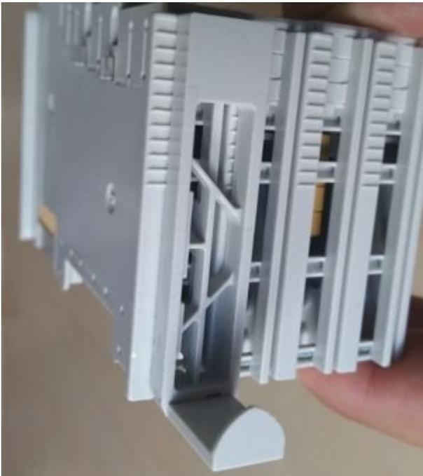
Abb. 6: Korrekt eingerasteter Halter, Frontansicht
