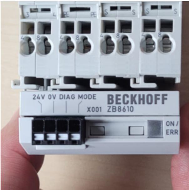
Abb. 11: Korrekt angebrachtes Lüftermodul, Frontansicht
