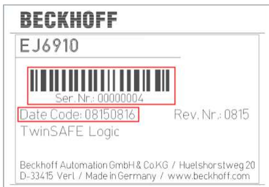
Abb. 4: Eindeutige Seriennummer eines TwinSAFE-EJ-Moduls
