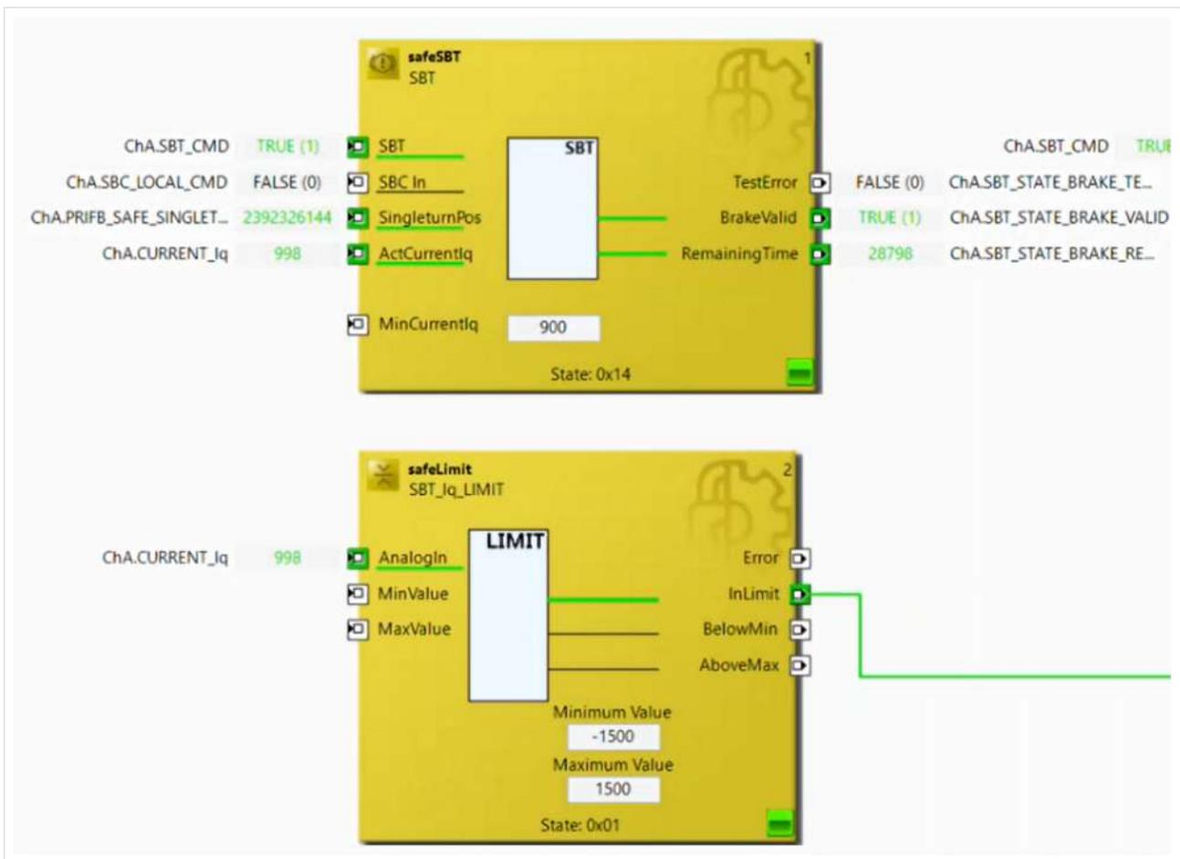
Im Online View sehen Sie jetzt, dass der SBT aktiviert wird. Zudem steigt der drehmomentbildende Strom auf über 900, der entsprechende Ausgang BrakeValid ist auf TRUE gesetzt und die Remaining Time zählt die Zeit zum nächsten SBT herunter.
