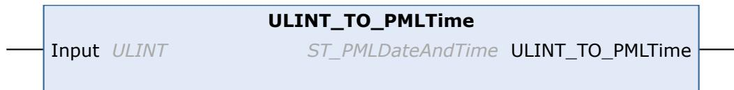
Die Funktion `ULINT_TO_PMLTime` konvertiert einen Zeitwert im ULINT-Format in das PackML-konforme Format.
