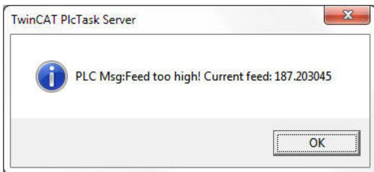
此处将 LREAL 值 187.203045 插入消息。插入点由格式字符串中的 %f 字符标记。输出时，该数值的小数部分会在第六位后被截断。
