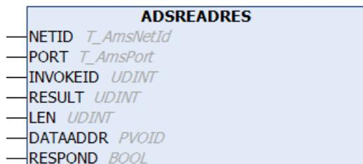
ADSREADRES 功能块用于确认 PLC 任务的指示。通过 RESPOND 输入端的上升沿，向 ADS 源设备发送响应。通过 PORT 和 NETID 参数，对源设备进行寻址。源设备通过 INVOKEID 参数将响应分配给请求，该参数也用于 [ADSREADIND \[▶ 25\]](#) 功能块的输出。通过 RESULT 参数可以向 ADS 源设备返回错误代码。
