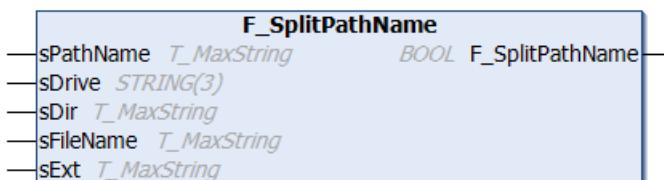
该函数将完整的路径名拆分成四个组成部分。分别存储在名为 sDrive、sDir、sFileName 和 sExt 的字符串中。
