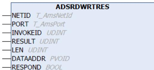
ADSRDWRTRES 功能块用于确认 PLC 任务的指示。通过 RESPOND 输入端的上升沿，向 ADS 源设备发送响应。通过 PORT 和 NETID 参数，对源设备进行寻址。INVOKEID 参数对源设备的请求响应进行排序，并被 [ADSRDWRTIND \[▶ 30\]](#) 功能块的输出所采用。通过 RESULT 参数可以向 ADS 源设备返回错误代码。
