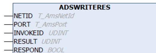
ADSWRITERES 功能块用于确认 PLC 任务的指示。通过 RESPOND 输入端的上升沿，向 ADS 源设备发送响应。通过 PORT 和 NETID 参数，对源设备进行寻址。INVOKEID 参数对源设备的请求响应进行排序，并被 [ADSWRITEIND \[▶ 25\]](#) 功能块的输出所采用。通过 RESULT 参数可以向 ADS 源设备返回错误代码。
