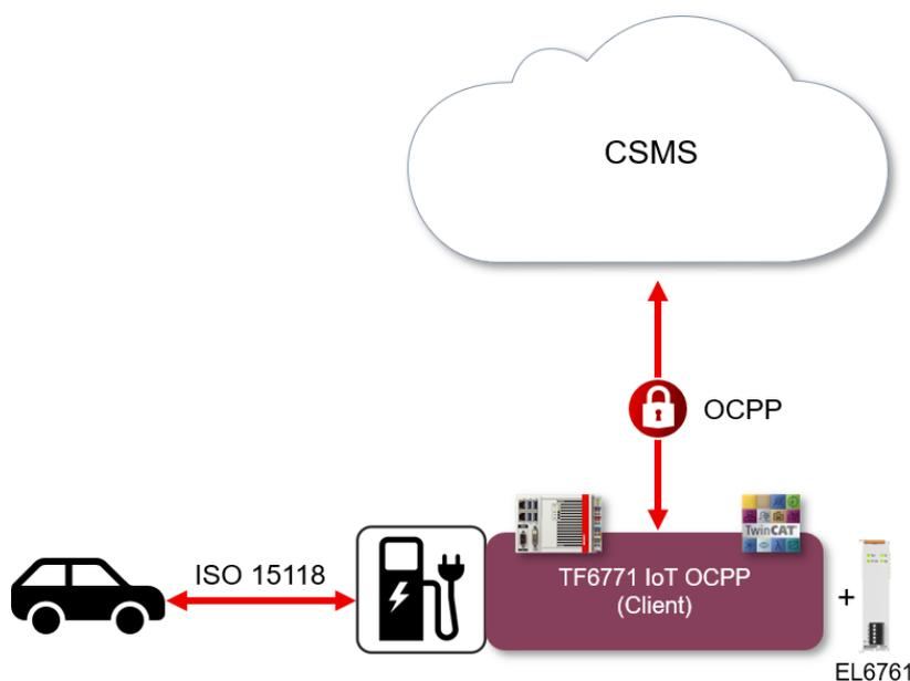
Softwareseitig wird die mit TwinCAT automatisierte Charging Station als OCPP-Client mit einem CSMS verbunden. Die Kommunikation in Richtung des zu ladenden Fahrzeugs wird über die EL6761 realisiert.
