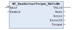
The function block determines the current actual force or actual pressure of an axis.
