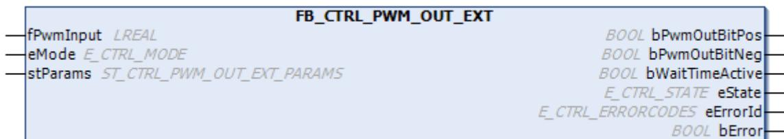
该功能块根据输入信号创建 PWM 调制信号。在该扩展型功能块中，除了脉宽占空比之外，还可以对最短接通时间和最短关断时间进行参数设置。
