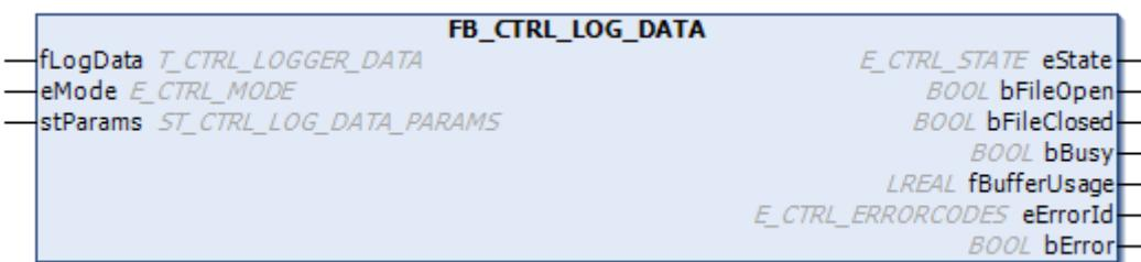
该功能块允许创建 \*.csv 格式（逗号分隔值）的日志文件，其中最多可记录 10 个变量。用户指定的列标题将写入该文件的第一行。输入数据将以相等的时间间隔写入后续行中。各个条目之间以逗号分隔。在 tLogCycleTime 参数中指定条目之间的时间间隔。例如，如果选择 tLogCycleTime := T\#2s，那么在文件中每 2s 就会记录一个条目。生成的文件可以通过电子表格程序等进行分析。
