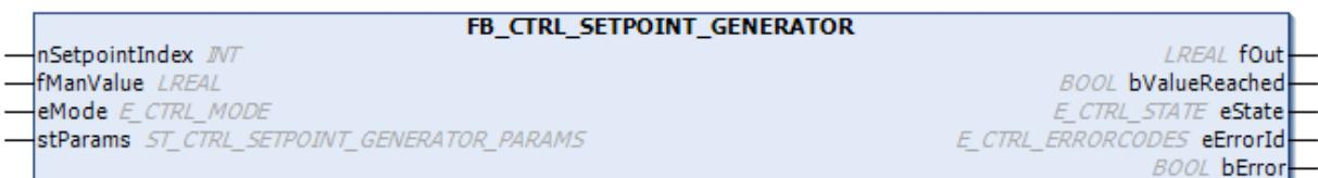
该功能块提供了一个设定值发生器，可输出从表中选择的设定值。从一个设定值到另一个设定值的转换可以连续进行，也可以不连续进行。
