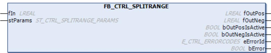
该功能块将输入信号分为正负分量。参数 bDisablePosOut 和 bDisableNegOut 可用于停用正输出或负输出 → 仅在冬季采用加热模式，仅在夏季采用冷却模式。bInvertNegOutput 参数允许对负输出进行反转。
