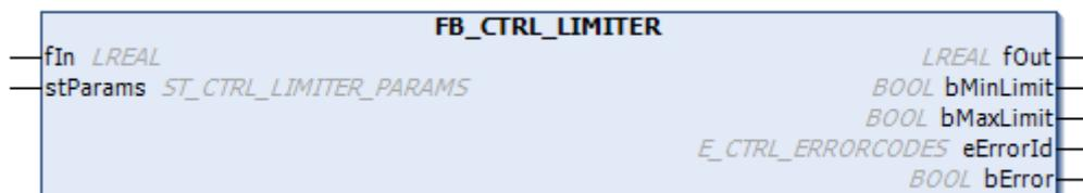
该功能块将输入信号限制在一个可参数化的区间内。
