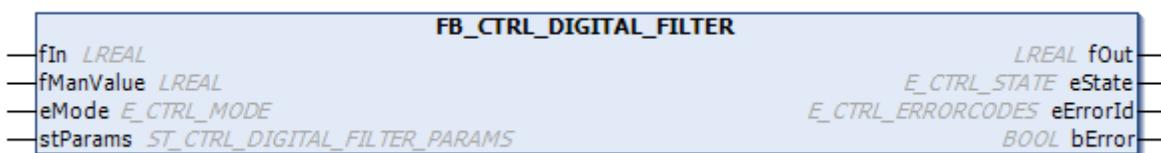
该功能块使用下述结构计算离散传递函数。该结构允许实现 FIR 滤波器（有限脉冲响应, **FIR**）或 IIR 滤波器（无限脉冲响应, **IIR**）。此处的传递函数可以是任意阶次 n。
