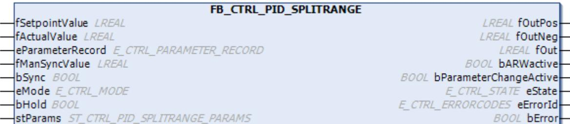
该功能块在功能图中提供了一个扩展型 PID 传递单元。在控制过程中，该控制器可实现两个参数集之间的切换。
