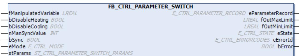
该功能块可用于切换 **FB\_CTRL\_PID\_SPLITRANGE** 所使用的参数集。
