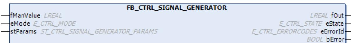
该功能块提供了一个信号发生器，可生成三角波、正弦波和锯齿波信号。
