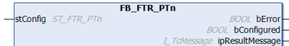
Der Funktionsbaustein FB\_FTR\_PTn realisiert ein Verzögerungsglied n-ter Ordnung mit gleichen Zeitkonstanten. Die komplexe Übertragungsfunktion (Laplace-Bereich):
