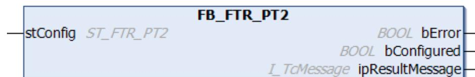
Der Funktionsbaustein FB\_FTR\_PT2 realisiert ein Verzögerungsglied 2. Ordnung (PT2-Glied) mit der komplexen Übertragungsfunktion (Laplace-Bereich):
