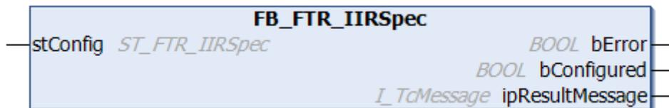
Der Funktionsbaustein realisiert einen IIR-Filter (Infinite-Impulse-Response-Filter).
