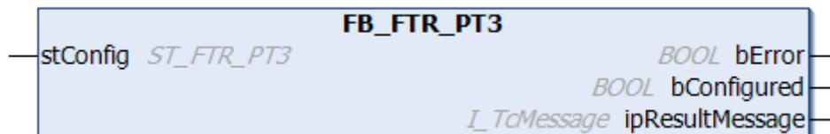
Der Funktionsbaustein FB\_FTR\_PT3 realisiert ein Verzögerungsglied 3. Ordnung (PT3-Glied) mit der komplexen Übertragungsfunktion (Laplace-Bereich):
