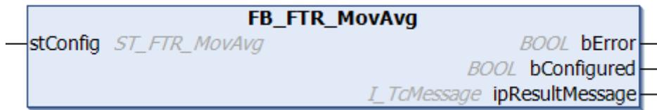
Der Funktionsbaustein realisiert einen Moving-Average-Filter. Das Filter bildet den Mittelwert aus M Eingangswerten  $x[n-k]$  mit  $k = 0 \dots M - 1$ .
