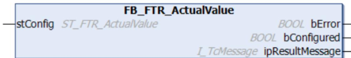
Der Funktionsbaustein ermöglicht eine Plausibilitätskontrolle und Filterung einer gemessenen Eingangsgröße.
