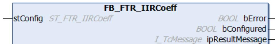
Der Funktionsbaustein realisiert einen IIR-Filter (Infinite-Impulse-Response-Filter). Die allgemeine Übertragungsfunktion lautet:
