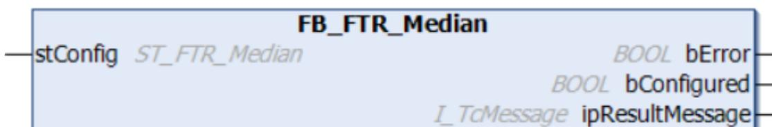
Der Funktionsbaustein realisiert einen Median-Filter. Der Median ist der mittlere Wert einer nach Größe geordneten Auflistung von Werten. Das bedeutet, dass die eine Hälfte der gesammelten Datenwerte kleiner als der Medianwert ist, die andere Hälfte größer.
