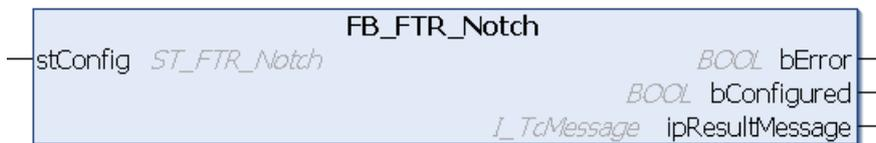
Der Funktionsbaustein FB\_FTR\_Notch realisiert einen Bandstopp-Filter mit schmaler Bandbreite. Die komplexe Übertragungsfunktion (Laplace-Bereich):
