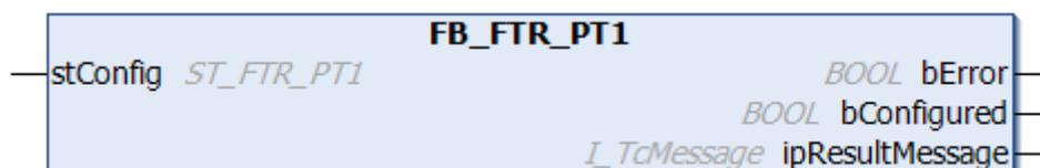
Der Funktionsbaustein FB\_FTR\_PT1 realisiert ein Verzögerungsglied 1. Ordnung (PT1-Glied) mit der komplexen Übertragungsfunktion (Laplace-Bereich):
