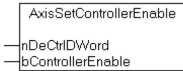
**AxisSetControllerEnable** setzt in *nDeCtrlDWord* das Reglerfreigabe-Signal gemäß dem Eingang *bControllerEnable* und liefert als Funktionsergebnis *nDeCtrlDWord* zurück.
