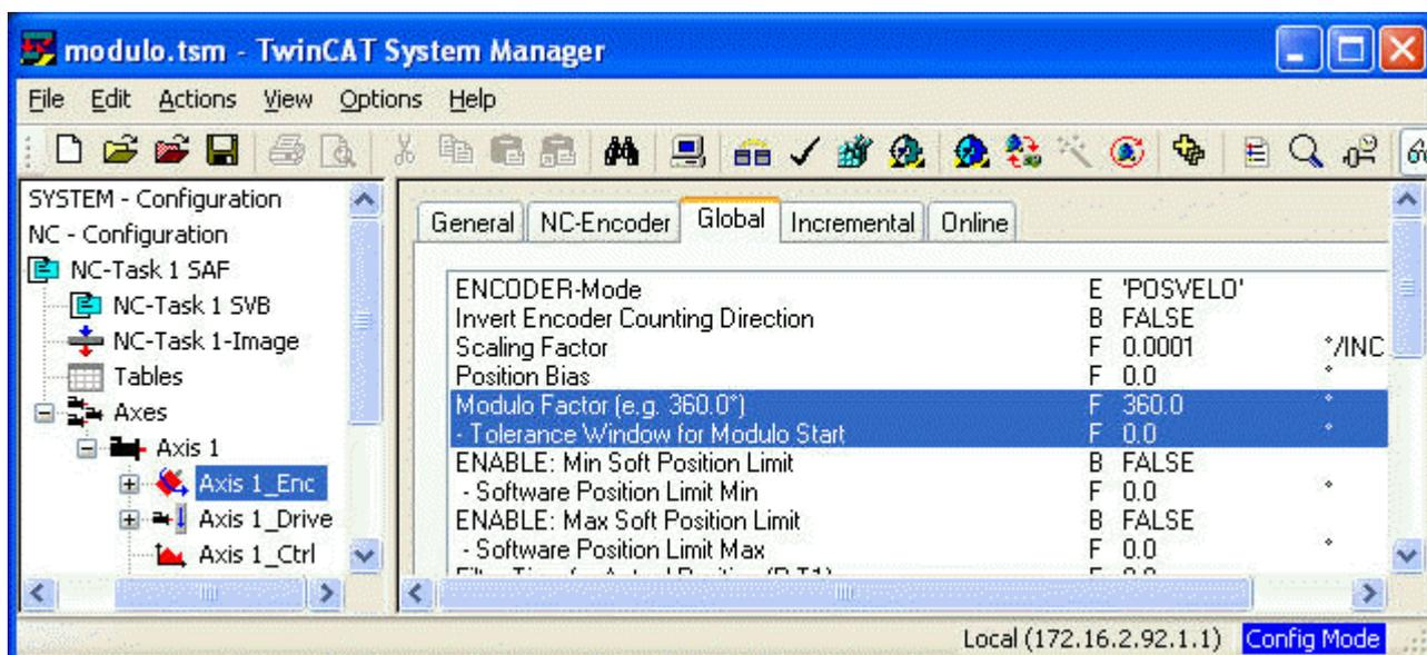
Das *Modulo-Toleranzfenster* definiert ein Positionsfenster um die aktuelle Modulo-Sollposition der Achse herum. Die Fensterbreite entspricht dem doppelten angegebenen Wert (Sollposition  $\pm$  Toleranzwert). Auf das Toleranzfenster wird im Folgenden näher eingegangen.
