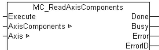
Mit dem Funktionsbaustein *MC\_ReadAxisComponents* werden Informationen zu den Unterelementen Encoder, Drive und Controller einer Achse gelesen.
