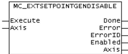
Mit dem Funktionsbaustein MC\_ExtSetPointGenDisable kann der externe Sollwertgenerator einer Achse ausgeschaltet werden. Anschließend übernimmt die Achse nicht mehr die Sollwertvorgaben aus ihrem zyklischen Achsinterface ( fExtSetPos, fExtSetVelo, fExtSetAcc und nExtSetDirection)
