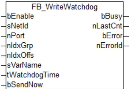
Schreiben eines Watchdogsignals in ein anderes ADS-Gerät (TwinCAT PLC, Busklemmen Controller, ...).
