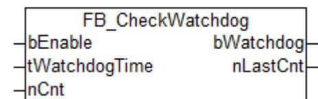
Überwachen eines Watchdogsignals, welches mit dem Baustein [FB\\_WriteWatchdog\(\) \[▶ 20\]](#) übertragen wird.
