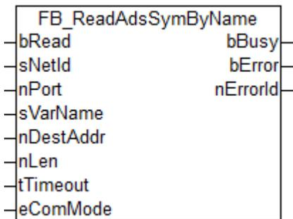
Der Baustein ermöglicht das Lesen eines beliebigen Wertes von einer anderen Steuerung, mit Hilfe des Symbolnamens.
