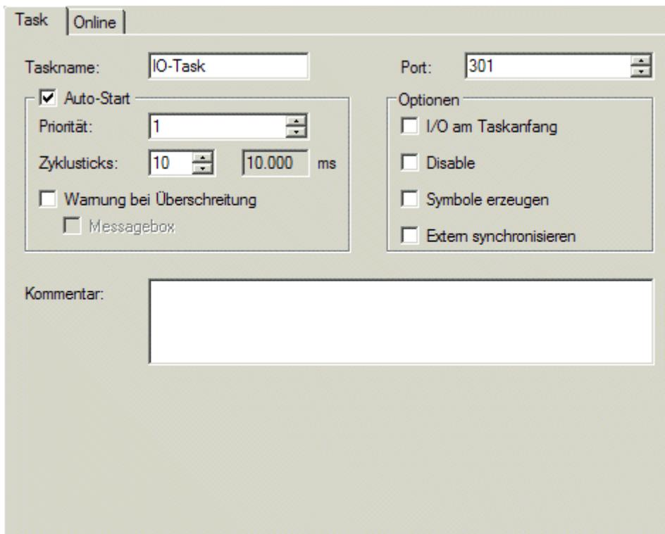
**Verknüpfen der IO-Task mit dem Feldbus-Device**
