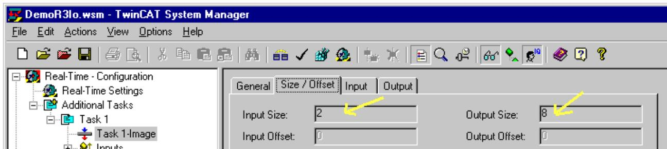
Die Portnummer und die Bytegröße des Prozessabbildes wurden in der *TCatIoOcxDelphiUnit.pas*-Unit als Konstanten definiert und müssen bei anderen Werten entsprechend geändert werden.
