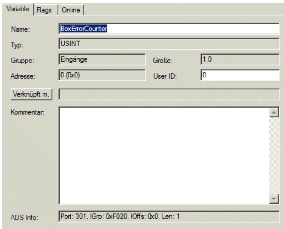
In dem Dialog "Variablenverknüpfung" werden jetzt die Variablen angezeigt, die verknüpft werden können. Die entsprechende Variable ist auszuwählen und der Dialog mit *Okay* zu verlassen:
