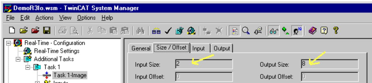
Die Portnummer und die Bytegröße des Prozessabbildes wurden in der **TCatIoDrv.pas**-Unit als Konstanten definiert und müssen bei anderen Werten entsprechend geändert werden.
