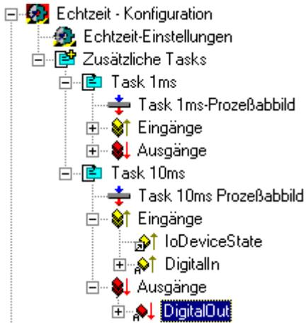
Um sicher zu stellen, dass die im System Manager benutzten Datentypen der Taskvariablen zur C++ Applikation passen, generiert der System Manager für jeden Task eine Header Datei.
