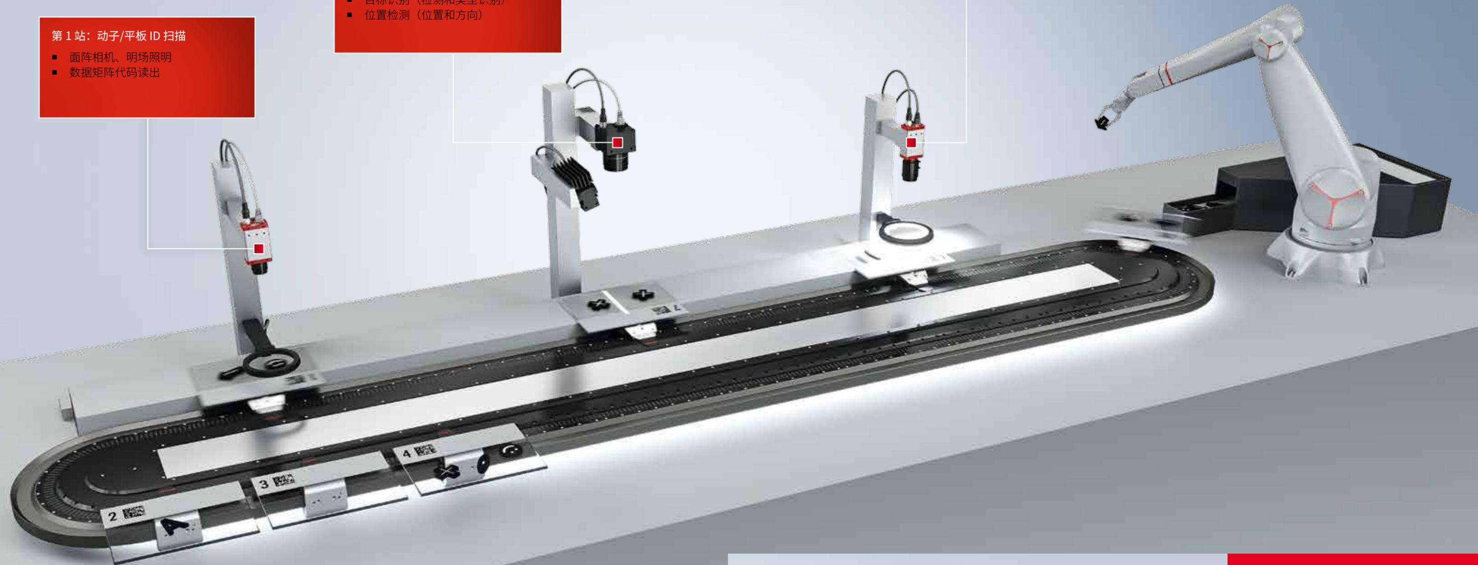
由于图像处理算法在与 PLC、运动控制和机器人相同的环境中执行，所有任务都可以轻松同步。对图像捕捉时序的确定十分精准（例如使用触发器），并且能够在给定的时间点上与轴或机器人位置进行协调。
