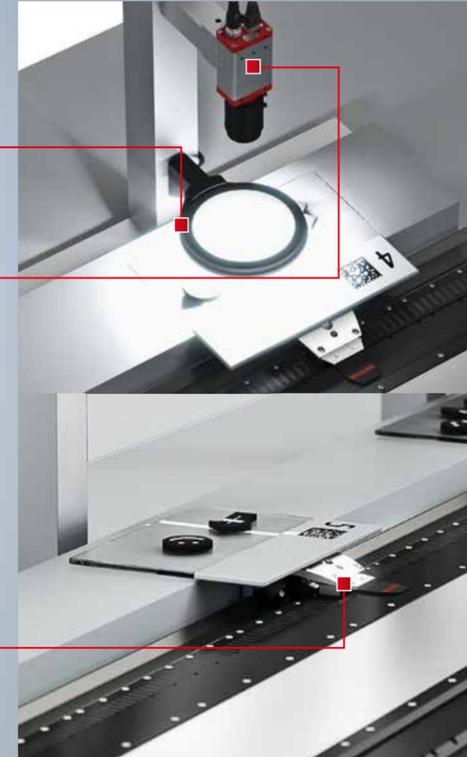
TwinCAT Vision 直接与 TwinCAT 开发环境集成。可以在新的 Vision 节点下轻松添加或配置相机，并在该节点下进行标定。它也能够捕捉相机图像流以及输入录制，而不是直接捕捉相机实时图像。或者，也可以加载
