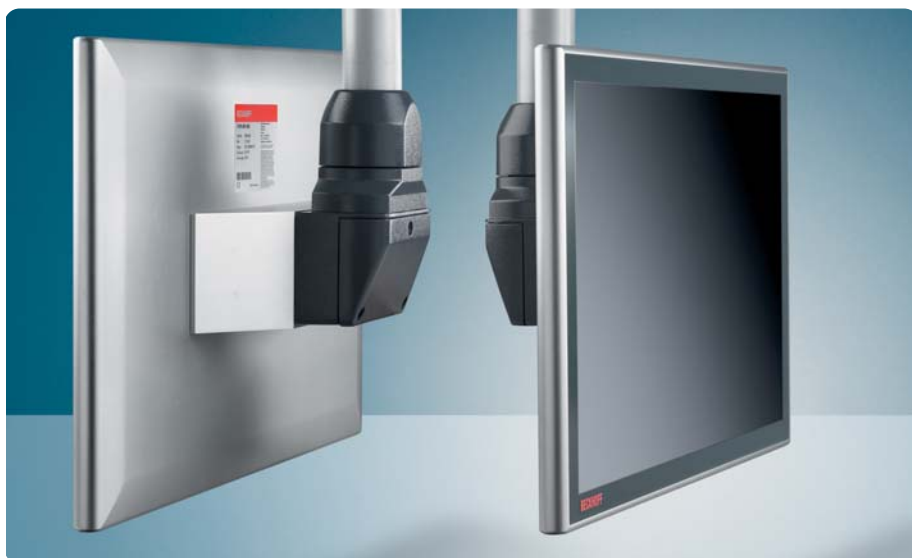
Bild 3: Die CP39xx-Control-Panel zur Tragarmmontage bieten rundum Schutzart IP65. Sie nutzen die bekannte DVI-/USB-Extended-Technologie von Beckhoff und können bis zu 50m entfernt vom Industrie-PC betrieben werden.
