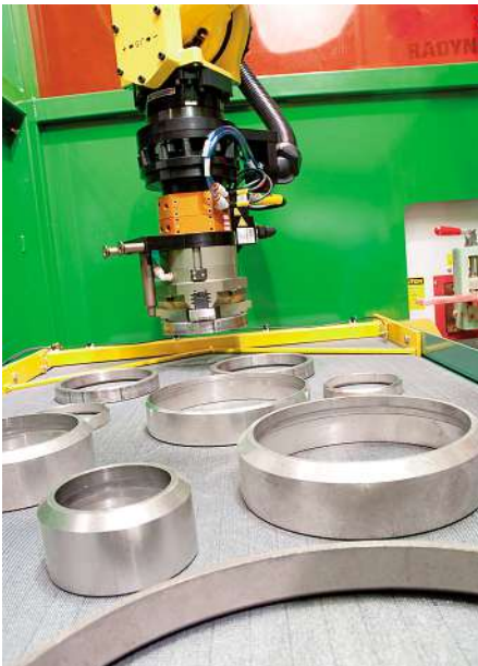
Der Roboter greift einen Endring vom Beschickungsförderband.
