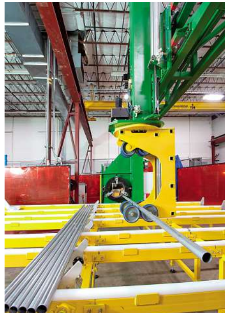
Über einen Hallenportalkran wird der auf Solllänge gebrachte Zylinder aufgenommen und in die servogesteuerte Spannvorrichtung eingelegt.
