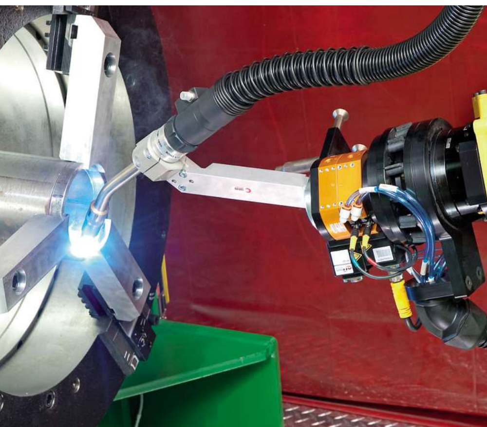
Der Roboter hat sich von der Greifvorrichtung zum Schweißbrenner bewegt und schweißt den Endring am Zylinder an.
