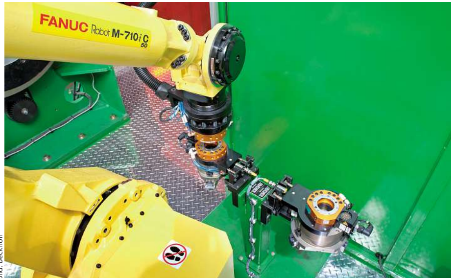
Der Roboter in der Wechselbewegung von der Greifvorrichtung zum Schweißbrenner.
