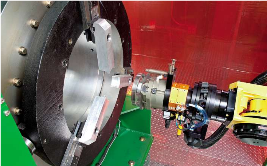
Der Endring sitzt im zweiten Spannbackensatz.
