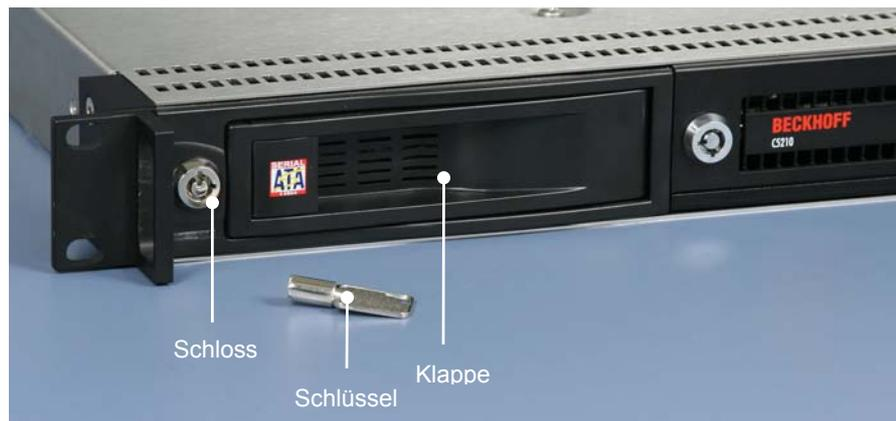
Die Festplatten befinden sich in zwei Wechselrahmen auf der Frontseite des Industrie-PCs. Nach dem Entriegeln der Wechselrahmen-Klappen mit dem Schlüssel lassen sich die Festplatten herauschwenken und entnehmen.
