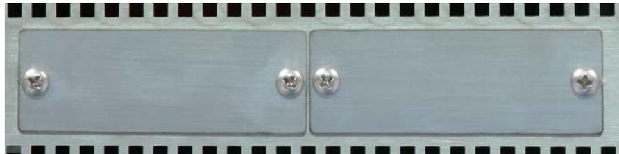
Für die Montage der Steckkarten lösen Sie zunächst die Kreuzschlitz-Schrauben. Die Abdeckkappen lassen sich nun entfernen und ermöglichen das Einsetzen der Steckkarten.
