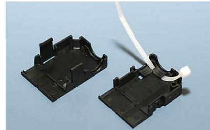
Setzen Sie die Steckerleiste in das Unterteil des Zugentlastungsgehäuses ein.
