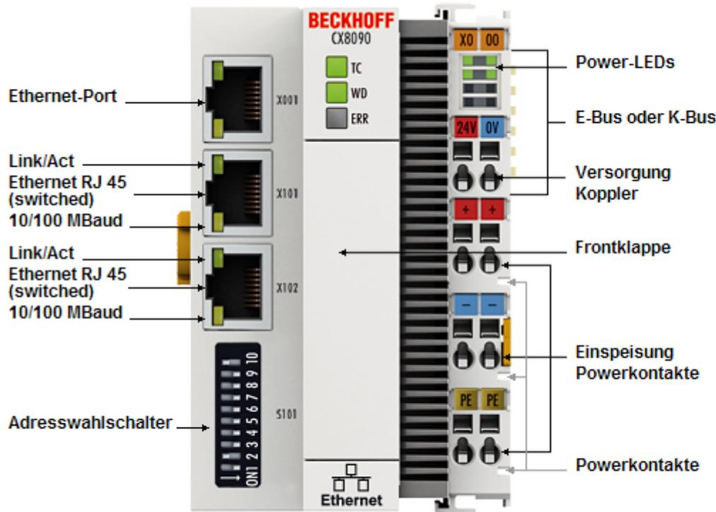
Der CX8090 ist eine Steuerung mit einem geschalteten Ethernet-Port. Es werden Protokolle, wie Realtime-Ethernet, ADS UDP/TCP, Modbus TCP Client/Server oder eine offene TCP/IP-UDP/IP-Kommunikation, unterstützt. Wahlweise können K-Bus- oder E-Bus-Klemmen angereiht werden; der CX8090 erkennt in der Hochlaufphase automatisch, welcher Klemmentyp angeschlossen ist. Programmiert wird die Steuerung mit TwinCAT über die Feldbusschnittstelle oder das zusätzliche Ethernet-Interface.
