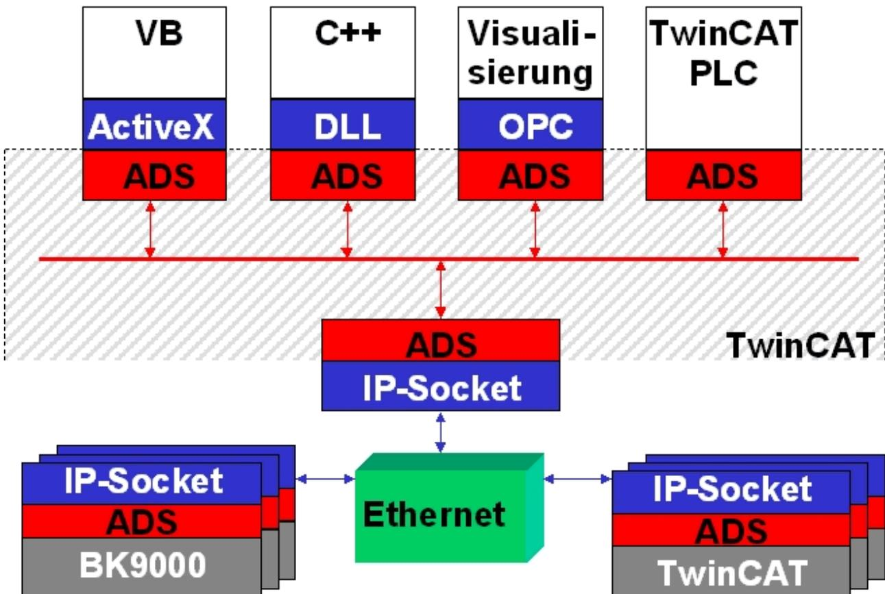
Das ADS-Protokoll wird auf das TCP/IP- oder UDP/IP-Protokoll aufgesetzt. Es ermöglicht dem Benutzer innerhalb des Beckhoff-Systems über nahezu beliebige Verbindungswege mit allen angeschlossenen Geräten zu kommunizieren und diese zu parametrieren. Außerhalb des Beckhoff-Systems stehen verschiedene Wege offen, um mit anderen Software-Tools Daten auszutauschen.
