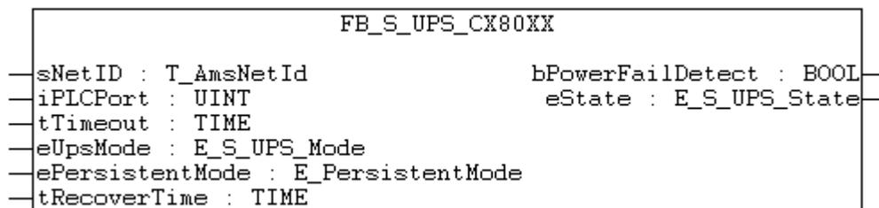
Der Funktionsbaustein FB\_S\_UPS kann auf CX80xx mit der Sekunden-USV verwendet werden, um die Sekunden-USV aus der SPS anzusteuern. Hiermit können bei Spannungsausfall noch die Persistenten Daten gespeichert und ein QuickShutdown ausgeführt werden. Wenn möglich sollten die Defaultwerte der INPUTs des FB\_S\_UPS beibehalten werden.
