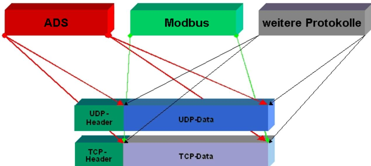
ADS setzt wahlweise auf TCP oder UDP auf, während ModbusTCP stets auf TCP/IP basiert.
