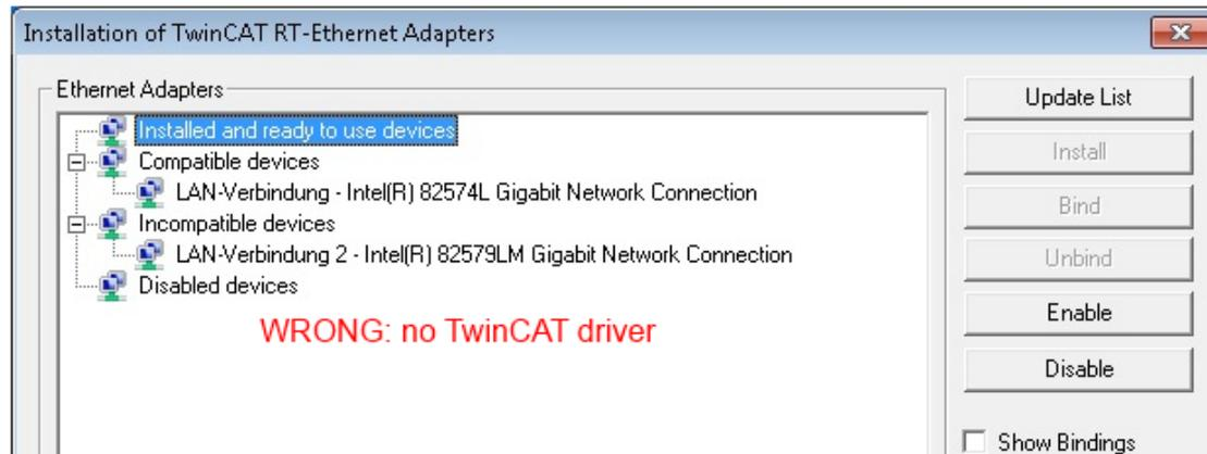
Abb. 161: Fehlerhafte Treiber-Einstellungen des Ethernet Ports
