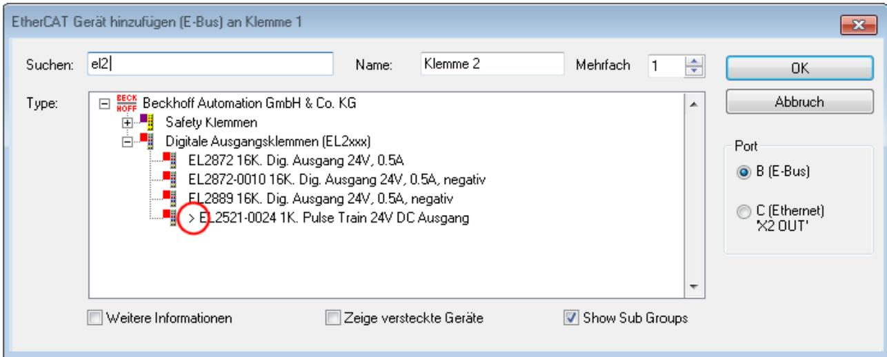
Abb. 167: Kennzeichnung einer online erfassten ESI am Beispiel EL2521
