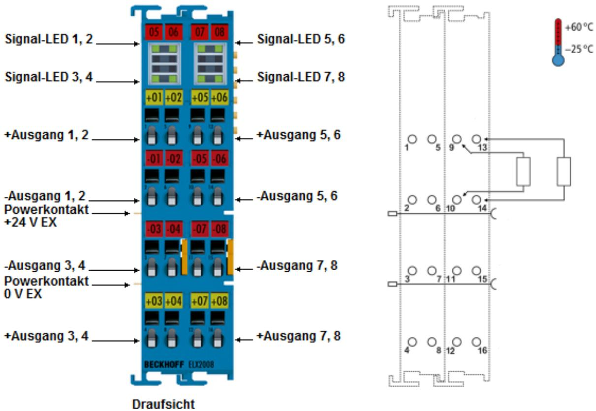
Abb. 21: ELX2008 - Anschlussbelegung
