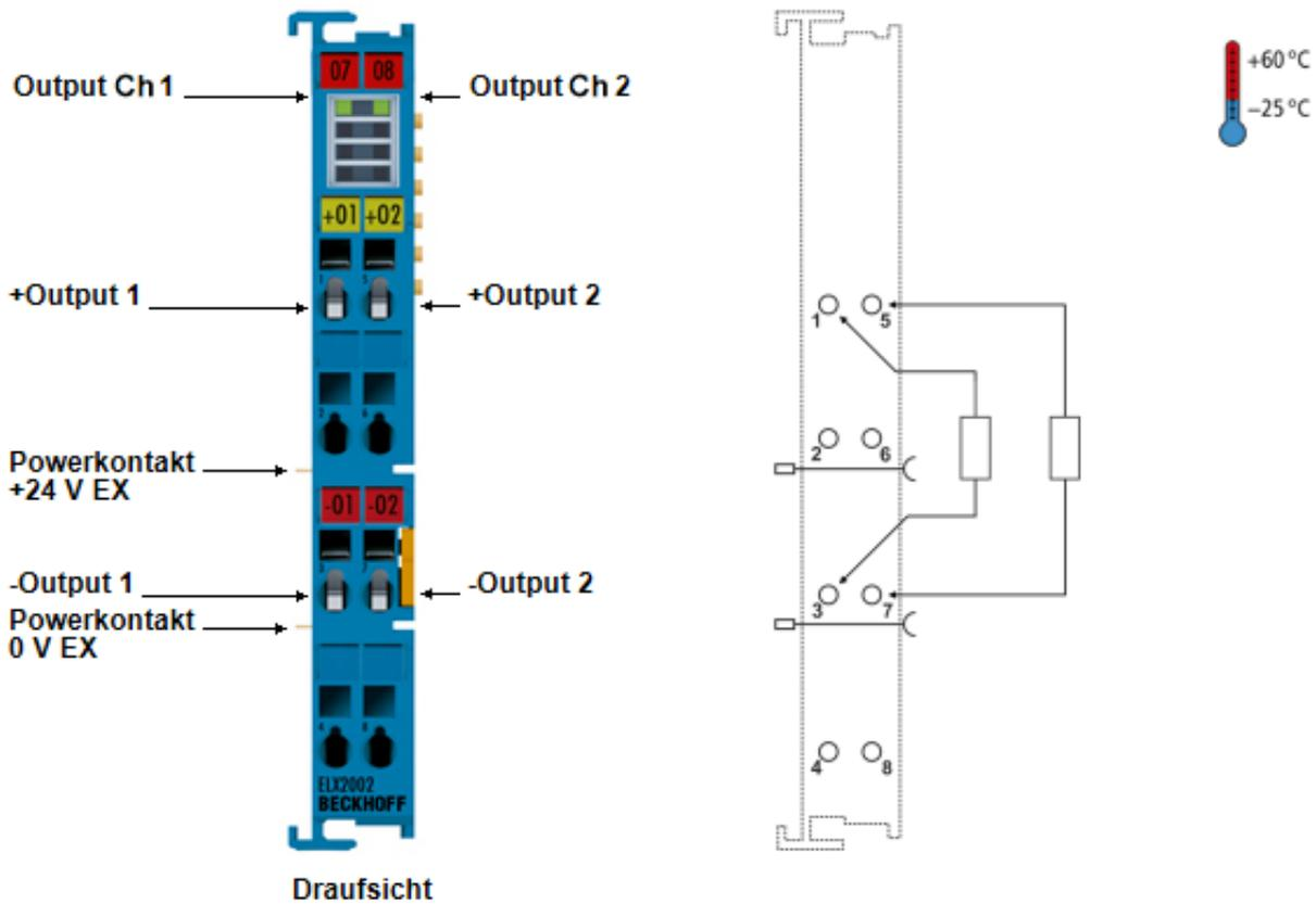
Abb. 20: ELX2002 - Anschlussbelegung
