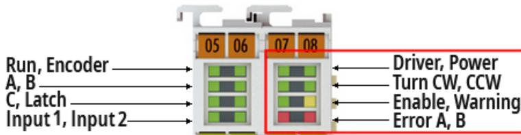
Abb. 40: EL7041-1000 LEDs (rechtes Prisma)
