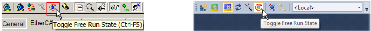
図 68: ボタンを使用してTwinCATをこの状態に切り替えることも可能(左: TwinCAT 2、右: TwinCAT 3)
