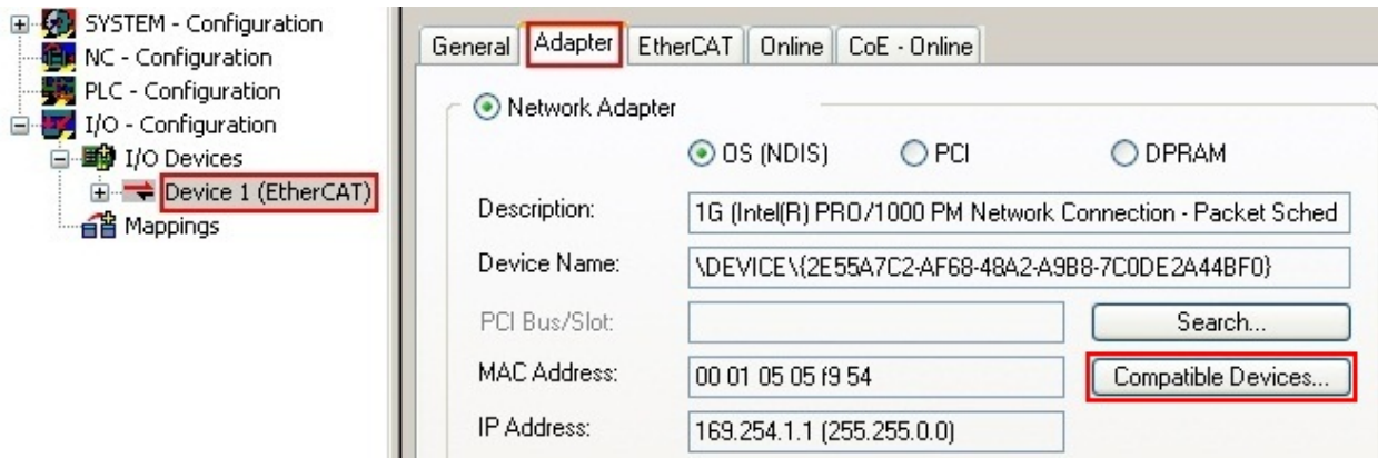
図 35: EtherCATデバイスのプロパティ (TwinCAT 2): タブ[Adapter]の[Compatible Devices]をクリック
