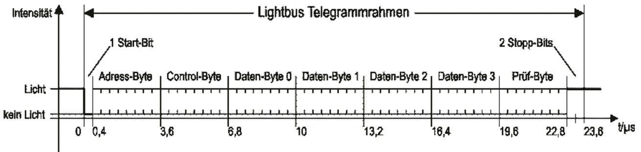
Abb. 6: Aufbau eines Lightbus Telegramms
