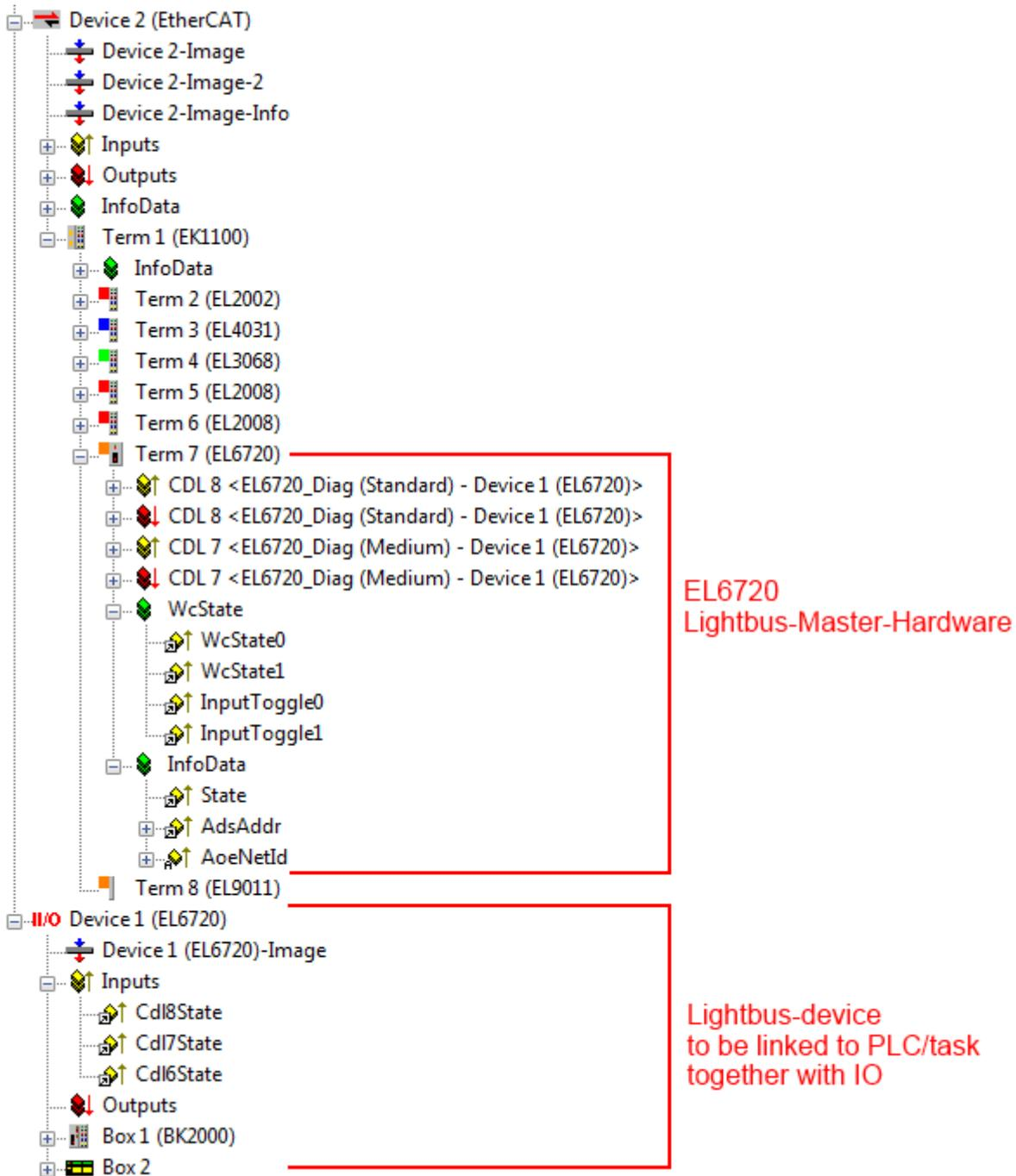
Abb. 131: Darstellung EL6720 Lightbus-Master-Hardware und Lightbus-device im TwinCAT Baum
