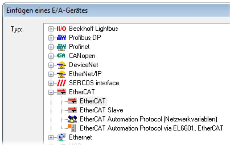
Abb. 78: Auswahl EtherCAT Anschluss (TwinCAT 2.11, TwinCAT 3)
