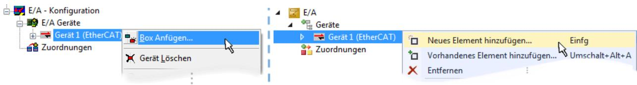
Abb. 81: Anfügen von EtherCAT-Geräten (links: TwinCAT 2; rechts: TwinCAT 3)
