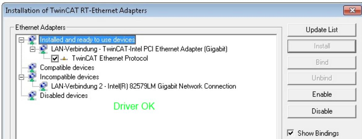
Abb. 66: Beispielhafte korrekte Treiber-Einstellung des Ethernet Ports
