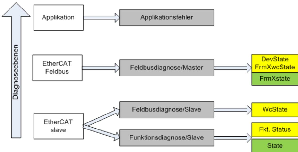
Abb. 118: Auswahl an Diagnoseinformationen eines EtherCAT Slave
