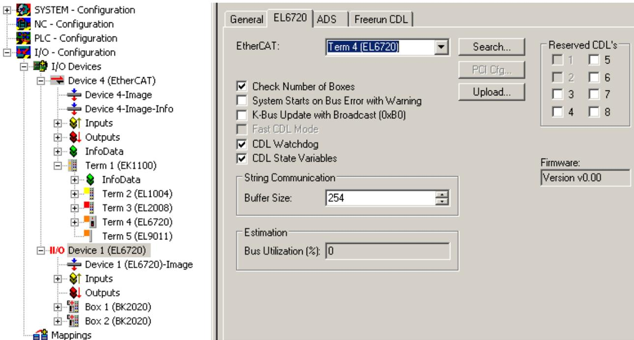
Abb. 134: Default Einstellungen eines EL6720-Lightbus-Gerätes
