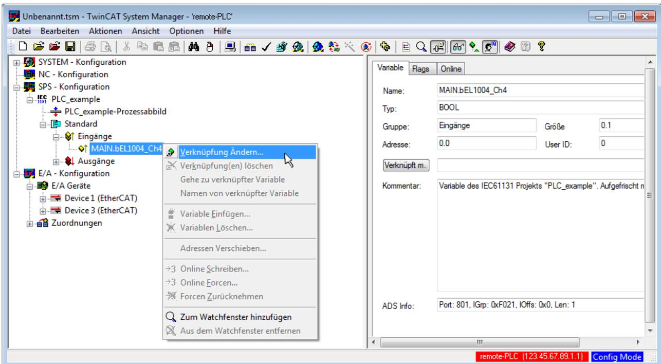
Abb. 31: Erstellen der Verknüpfungen PLC-Variablen zu Prozessobjekten
