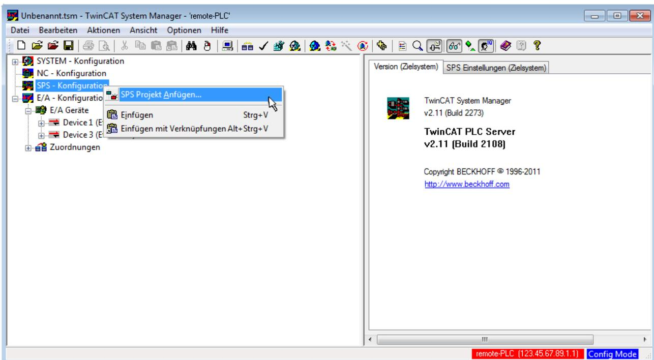
Abb. 29: Hinzufügen des Projektes des TwinCAT PLC Control
