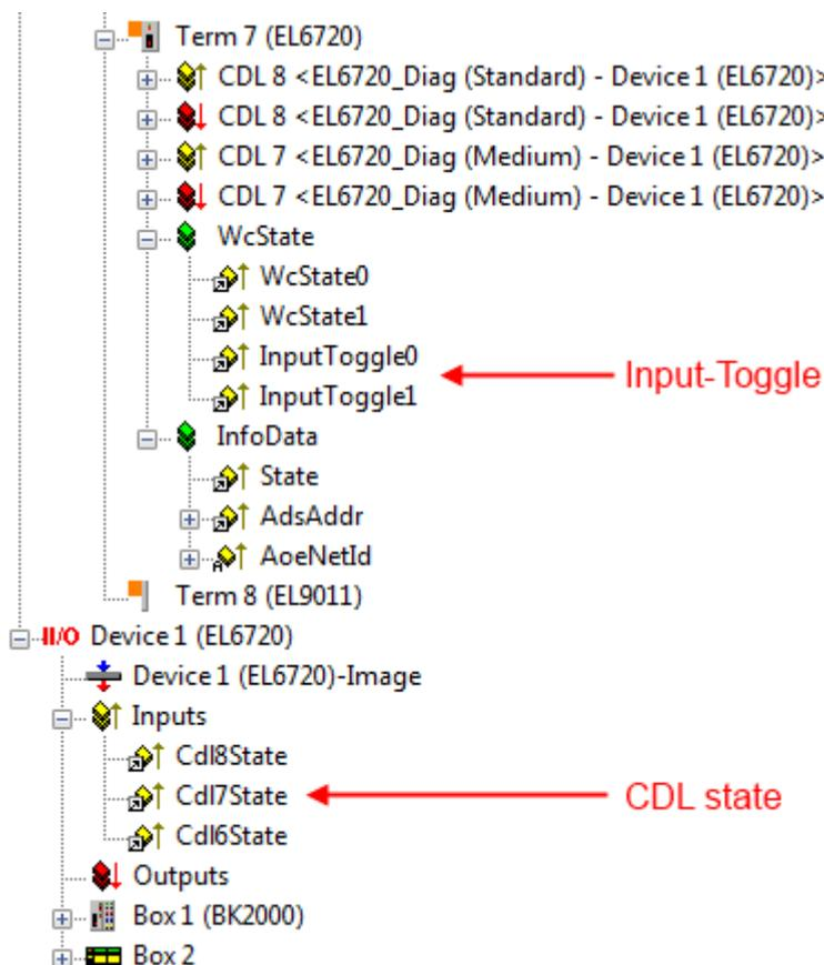
Abb. 127: EL6720 - Input-Toggle und CDLstate im TwinCAT Baum
