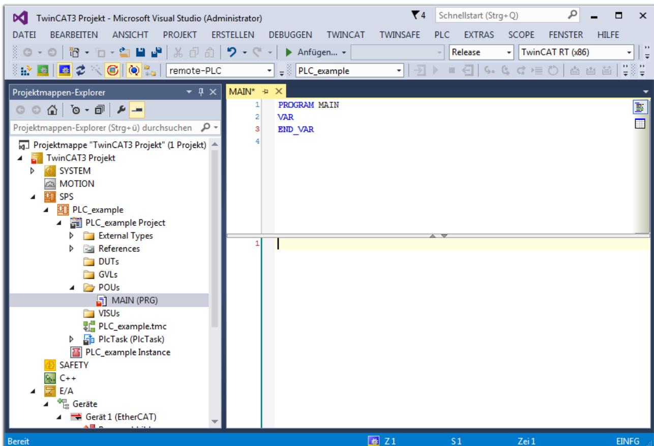
Abb. 48: Initiales Programm „Main“ des Standard PLC Projektes
