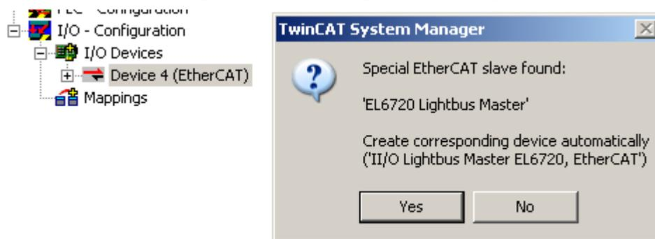
Abb. 133: Scan der vorhandenen Lightbus Geräte
