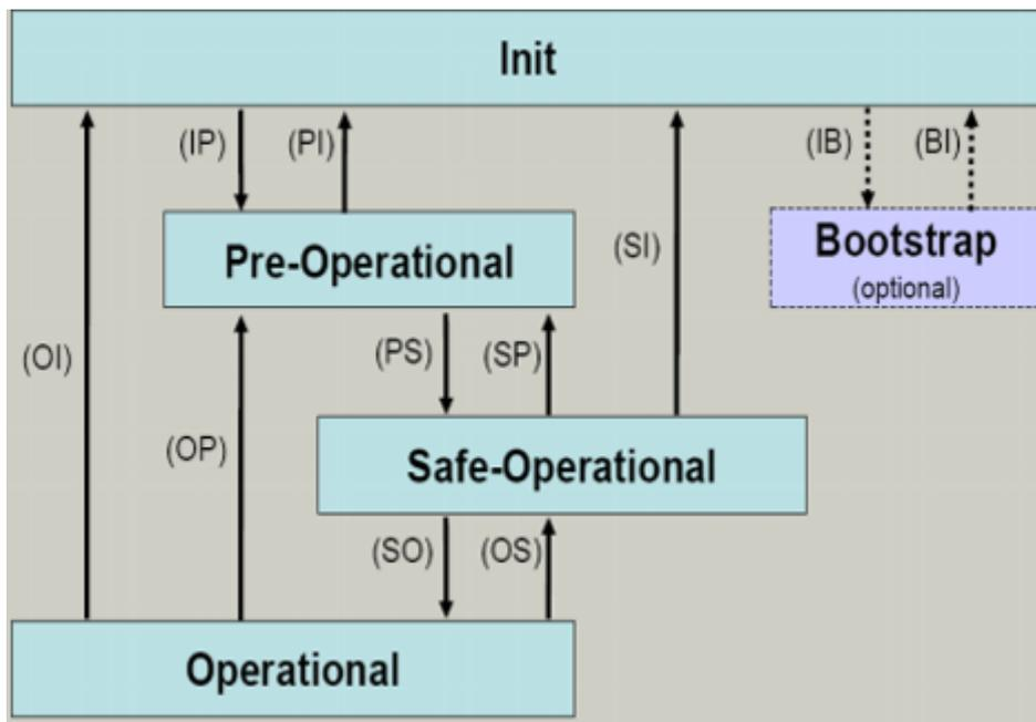
Abb. 7: Zustände der EtherCAT State Machine
