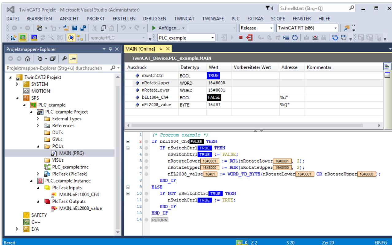
Abb. 59: TwinCAT 3 Entwicklungsumgebung (VS Shell): Logged-in, nach erfolgten Programmstart
