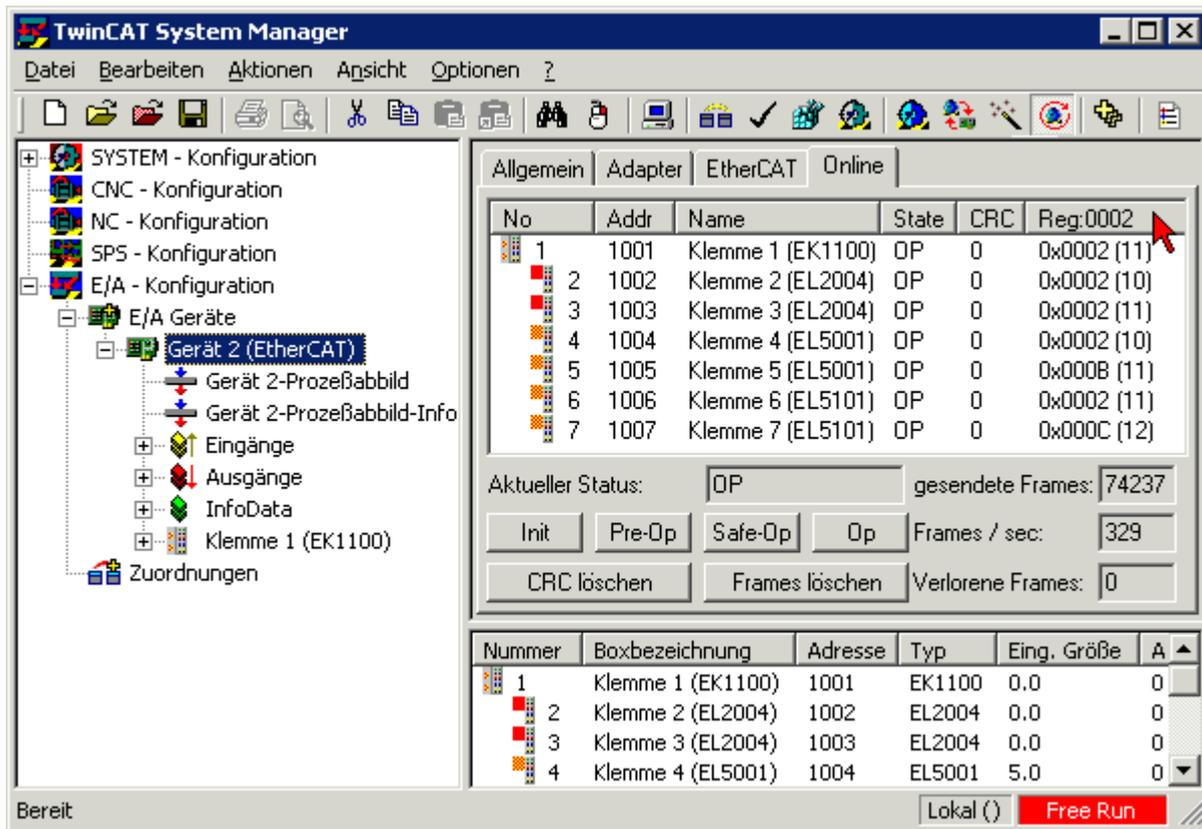
Abb. 151: Versionsbestimmung FPGA-Firmware
