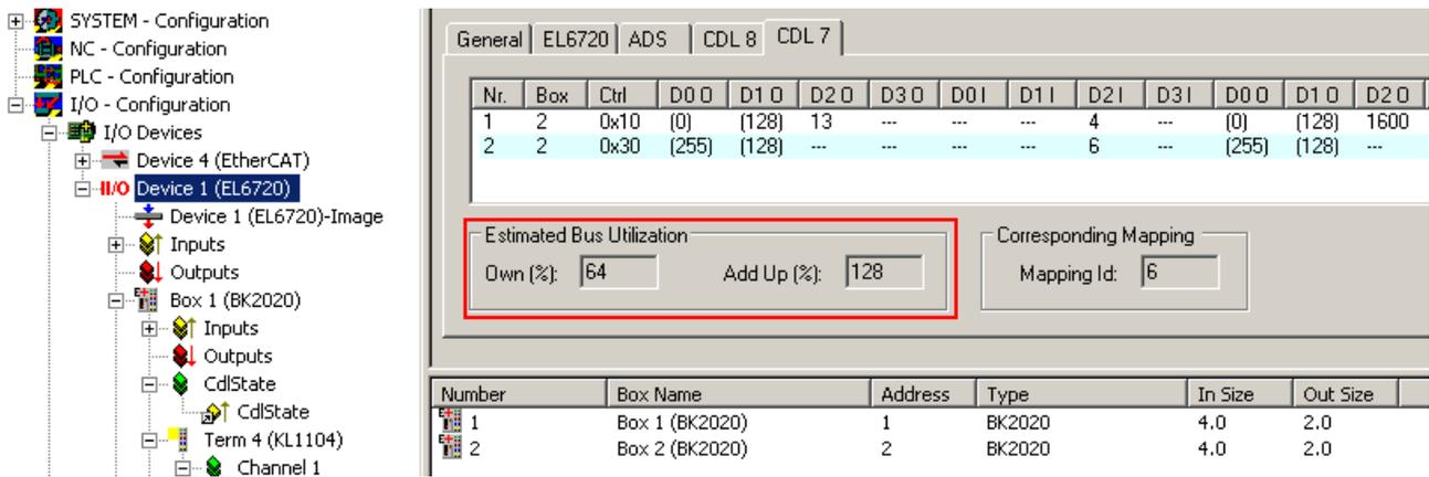
Abb. 137: Anteil einzelner CDL an der Auslastung
