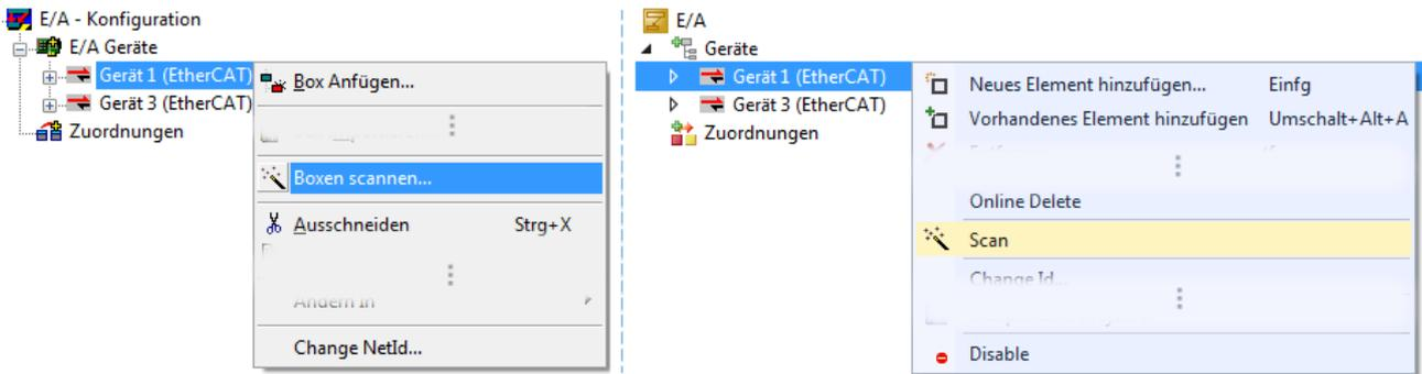
Abb. 95: Manuelles Scannen nach Teilnehmern auf festgelegtem EtherCAT Device (links: TC2; rechts TC3)
