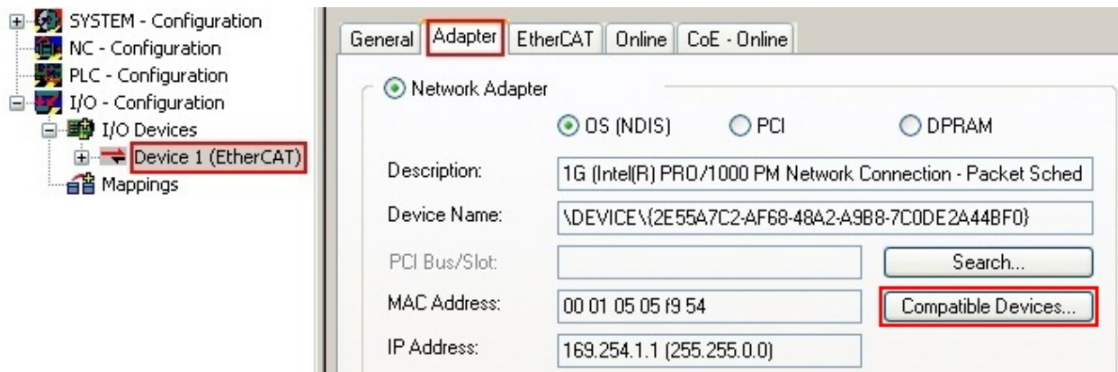
附图 96: EtherCAT 设备属性 (TwinCAT 2) : 点击“适配器”选项卡的“兼容设备...”
