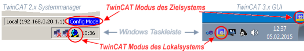
Abb. 85: Unterscheidung Lokalsystem/ Zielsystem (links: TwinCAT 2; rechts: TwinCAT 3)
