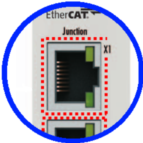
Abb. 6: Kennzeichnung FHC-Port am EK1122-0080 bzw. EK1101-0080
