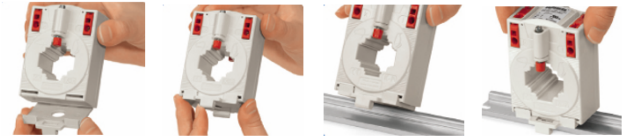
Abb. 32: Montage auf 35 mm DIN-Hutschiene mit Schnappbefestigung (ZB8201-0210)
