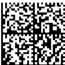
Abb. 16: Beispiel-DMC 1P 072222 SBTN k4p562d7 1K EL1809 Q 1 51S 678294
