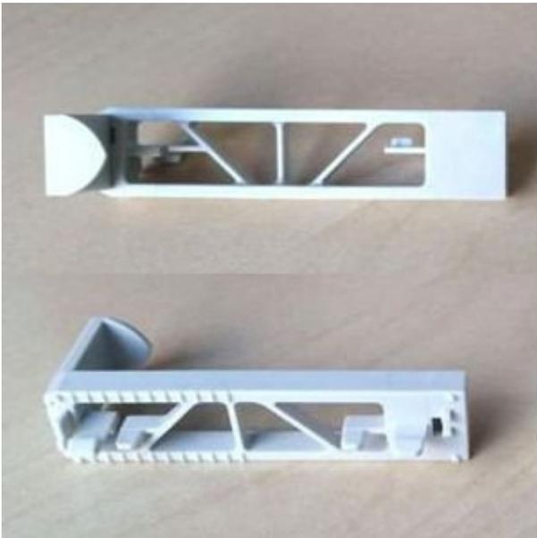
Abb. 3: Halterung Lüftermodul, 8 Kanal
