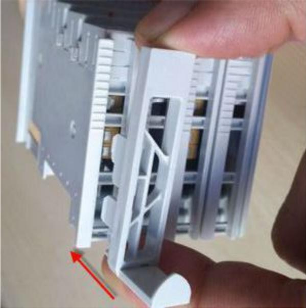
Abb. 5: Einrasten des Halters für Lüftermodul
