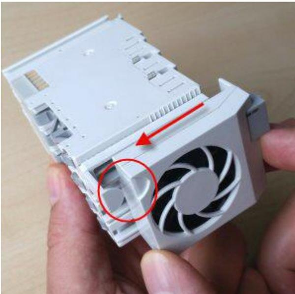
Abb. 9: Lüftermodul mit Aussparung über Haltenase schieben
