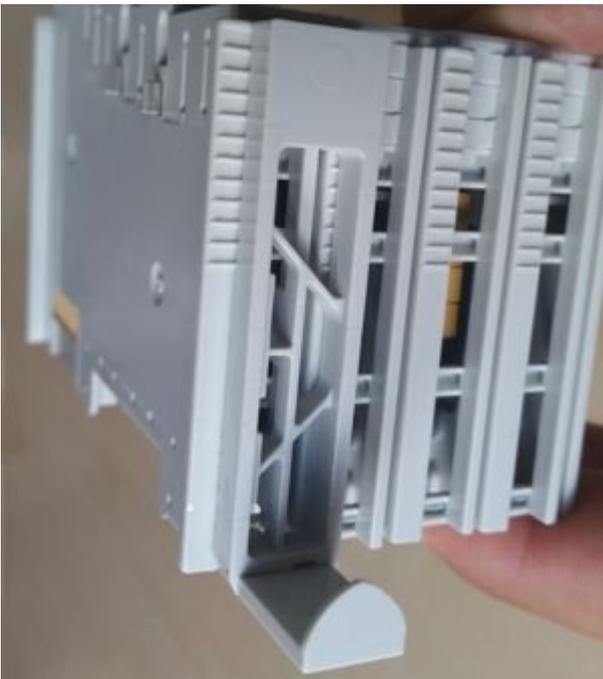
Abb. 6: Korrekt eingerasteter Halter, Frontansicht
