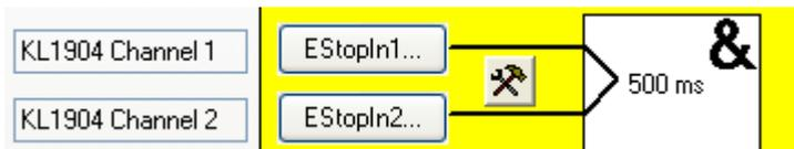
Le test capteur de ces deux canaux doit être paramétré sur « actif ».
