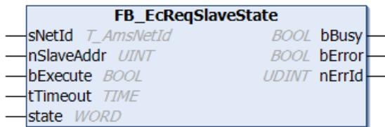
Mit dem Funktionsbaustein kann ein Slave in einen vorgegebenen EtherCAT-Zustand gesetzt werden. Der geforderte EtherCAT-Zustand wird in der Variablen state übergeben. Sobald der Funktionsbaustein den Befehl zum Zustandswechsel abgeschickt hat, wird er inaktiv. Im Unterschied zum Funktionsbaustein FB\_EcSetSlaveState wartet er nicht, bis der EtherCAT-Slave den neuen Zustand erreicht hat.
