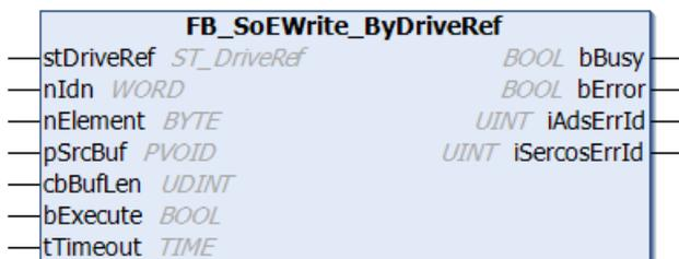
Mit dem Funktionsbaustein FB\_SoeWrite\_ByRef können Antriebsparameter mit Hilfe des "Sercos over EtherCAT (SoE)"-Protokolls beschrieben werden. Dazu muss der Slave eine Mailbox besitzen und das SoE-Protokoll unterstützen. Der zu schreibende Antriebs-Parameter wird mit den Parametern nIdn ( Identification number), nElement und stDriveRef spezifiziert.
