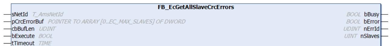
Mit dem Funktionsbaustein FB\_EcGetAllSlaveCrcErrors können die CRC-Error-Zähler aller am Master angeschlossenen Slaves ausgelesen werden. Die CRC-Error an den einzelnen Ports eines Slaves werden addiert.
