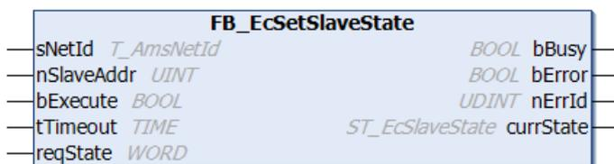
Mit dem Funktionsbaustein kann ein Slave in einen vorgegebenen EtherCAT-Zustand gesetzt werden. Der geforderte EtherCAT-Zustand wird in der Variablen reqState übergeben. Der Funktionsbaustein schickt den Befehl zum Zustandswechsel ab und bleibt im Unterschied zum Funktionsbaustein FB\_EcRegSlaveState so lange aktiv, bis der EtherCAT-Slave den neuen Zustand erreicht hat oder die maximale tTimeout-Zeit überschritten wird. Der aktuelle Zustand wird in der Variablen currState ausgegeben.
