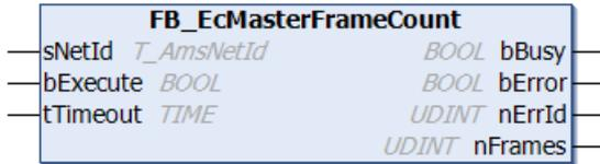
Mit dem Funktionsbaustein FB\_EcMasterFrameCount kann die Anzahl der EtherCAT-Frames, die im Master konfiguriert sind, ermittelt werden.
