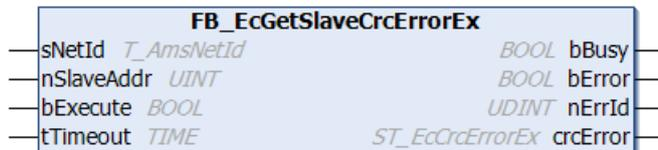
Mit dem Funktionsbaustein FB\_EcGetSlaveCrcErrorEx können die CRC-Error-Zähler der einzelnen Ports (A, D, B und C) eines Slave ausgelesen werden. Bei erfolgreichem Aufruf enthält die Ausgangsvariable crcError vom Typ ST\_EcCrcErrorEx die angeforderten CRC-Error-Zähler.
