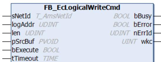
Mit dem Funktionsbaustein FB\_EcLogicalWriteCmd wird ein logisches EtherCAT-Write-Kommando (LWR) vom Master gesendet. In jedem Slave können lokale Adressbereiche (DPRAM) auf globale logische Adressbereich gemappt werden. Somit adressiert dieses Kommando alle EtherCAT-Slaves, die ein Mapping für den ausgewählten logischen Adressbereich konfiguriert haben.
