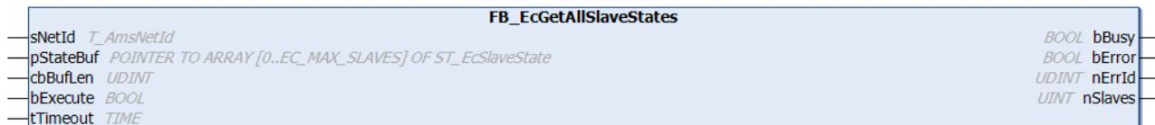
Mit dem Funktionsbaustein FB\_EcGetAllSlaveStates kann der EtherCAT-Status und der Link-Status von allen an den Master angeschlossenen Slaves ausgelesen werden. Bei erfolgreichem Aufruf enthält der im Parameter pStateBuf übergebene Puffer die angeforderte Status-Information als Array vom Typ ST\_EcSlaveState.
