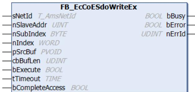
Mit dem Funktionsbaustein `FB_EcCoeSdoWriteEx` kann per SDO-Download ein Objekt aus dem Objektverzeichnis eines EtherCAT Slaves beschrieben werden. Dazu muss der Slave eine Mailbox besitzen und das "CANopen over EtherCAT (CoE)"-Protokoll unterstützen. Mit Hilfe der Parameter `nSubIndex` und `nIndex` wird ausgewählt, welches Objekt beschrieben werden soll. Über `bCompleteAccess := TRUE` kann der Parameter mit Unterelementen geschrieben werden.
