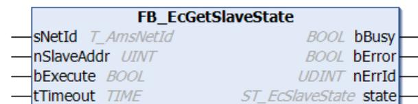
Mit dem Funktionsbaustein FB\_EcGetSlaveState kann der EtherCAT-Status und der Link-Status eines einzelnen EtherCAT-Slave-Gerätes ausgelesen werden. Bei erfolgreichem Aufruf enthält die Ausgangsvariable state vom Typ ST\_EcSlaveState die angeforderte Status-Information.
