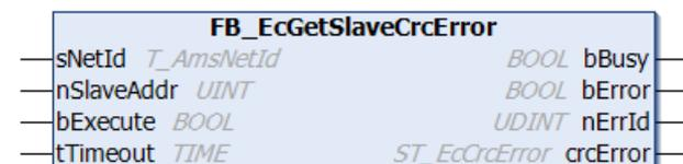
Mit dem Funktionsbaustein `FB_EcGetSlaveCrcError` können die CRC-Error-Zähler der einzelnen Ports (A, B und C) eines Slave ausgelesen werden. Bei erfolgreichem Aufruf enthält die Ausgangsvariable `crcError` vom Typ `ST_EcCrcError` die angeforderten CRC-Error-Zähler.
