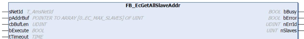
Mit dem Funktionsbaustein `FB_EcGetAllSlaveAddr` können die Adressen von allen an den Master angeschlossenen Slaves ausgelesen werden. Bei erfolgreichem Aufruf enthält der im Parameter `pAddrBuf` übergebene Puffer die Adressen aller Slaves als Array von UINTs.
