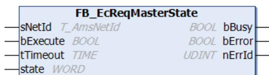
Mit dem Funktionsbaustein kann der EtherCAT-Zustand eines Master-Geräts angefordert und gesetzt werden. Der geforderte EtherCAT-Zustand wird in der Variablen state übergeben. Sobald der Funktionsbaustein den EtherCAT-Zustand angefordert hat, wird er inaktiv. Im Gegensatz zum Funktionsbaustein FB\_EcSetMasterState wartet er nicht, bis der neue Zustand gesetzt ist.
