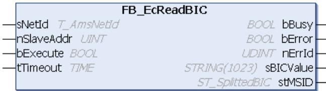
Mit dem Funktionsbaustein FB\_EcReadBIC kann per ADS die BIC aus dem EEPROM eines EtherCAT-Slaves ausgelesen werden. Dazu muss der Slave die BIC im EEPROM enthalten.
