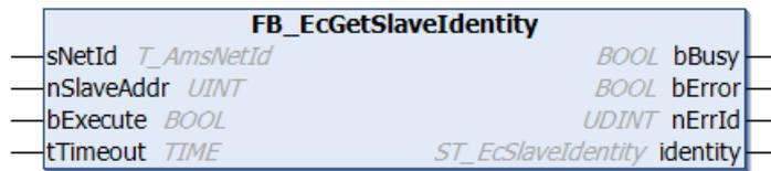
Mit dem Funktionsbaustein `FB_EcGetSlaveIdentity` kann die CANopen Identity eines einzelnen EtherCAT-Slave-Gerätes ausgelesen werden. Bei erfolgreichem Aufruf enthält die Ausgangsvariable `identity` vom Typ `ST_EcSlaveIdentity` die angeforderte Identity-Information.
