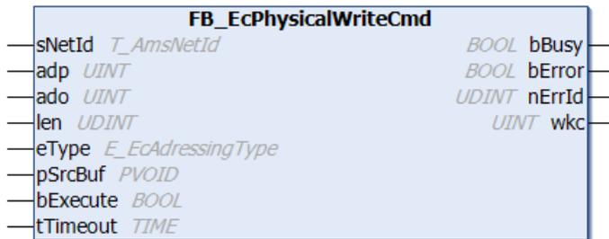
Mit dem Funktionsbaustein FB\_EcPhysicalWriteCmd kann ein EtherCAT-Write-Kommando (FPWR, APWR, BWR) an einen bestimmten EtherCAT-Slave oder an alle EtherCAT-Slaves gesendet werden. Dieses Kommando kann von der SPS verwendet werden, um ein Register oder den DPRAM des EtherCAT Slave Controllers zu beschreiben.
