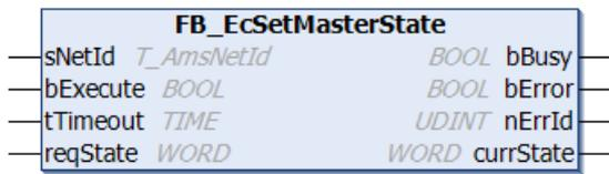
Mit dem Funktionsbaustein kann der EtherCAT-Zustand eines Master-Geräts angefordert und gesetzt werden. Der geforderte EtherCAT-Zustand wird mit der Variablen `reqState` übergeben. Der Funktionsbaustein fordert den EtherCAT-Zustand an und bleibt im Gegensatz zum Funktionsbaustein `FB_EcReqMasterState` aktiv, bis der neue Zustand gesetzt oder die maximale `tTimeout`-Zeit überschritten wird. Der aktuelle Zustand wird in der Variablen `currState` ausgegeben.
