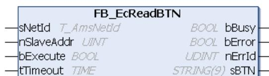
Mit dem Funktionsbaustein FB\_EcReadBTN kann per ADS die BTN aus dem EEPROM eines EtherCAT-Slaves ausgelesen werden. Dazu muss der Slave die BIC im EEPROM enthalten.
