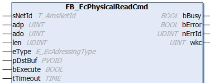
Mit dem Funktionsbaustein FB\_EcPhysicalReadCmd kann ein EtherCAT-Lese-Kommando (FPRD, APRD, BRD) an einen bestimmten EtherCAT-Slave oder an alle EtherCAT-Slaves gesendet werden. Dieses Kommando kann von der SPS verwendet werden, um ein Register oder den DPRAM des EtherCAT Slave Controllers auszulesen.
