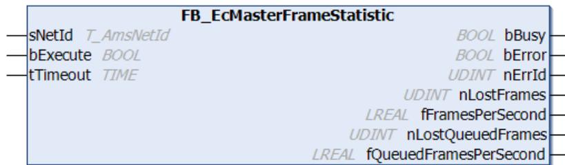
Mit dem Funktionsbaustein `FB_EcMasterFrameStatistic` kann die Frame-Statistik des EtherCAT-Masters ausgelesen werden. Es wird zwischen zyklischen und azyklischen (queued) Frames unterschieden. Azyklische Frames werden z.B. für die Initialisierung oder für Parameterzugriffe auf EtherCAT-Slaves verwendet. Frames gelten dann als verloren, wenn sie nicht zum Master zurückkommen oder wenn sie ungültig sind.
