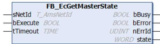
Mit dem Funktionsbaustein FB\_EcGetMasterState kann der EtherCAT-Zustand des Masters ausgelesen werden. Bei erfolgreichem Aufruf enthält die Ausgangsvariable state vom Typ WORD die angeforderte Status-Information.
