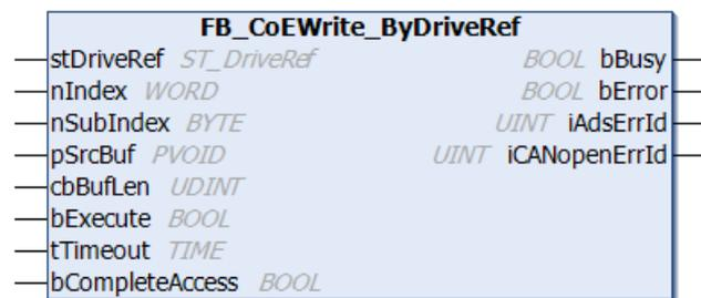
Mit dem Funktionsbaustein FB\_CoEWrite\_ByDriveRef können Antriebsparameter mit Hilfe des "CANopen over EtherCAT (CoE)"-Protokolls geschrieben werden. Dazu muss der Slave eine Mailbox besitzen und das "CANopen over EtherCAT (CoE)"-Protokoll unterstützen. Mit Hilfe der Parameter nSubIndex und nIndex wird ausgewählt, welches Objekt beschrieben werden soll. Über bCompleteAccess := TRUE kann der Parameter mit Unterelementen geschrieben werden.
