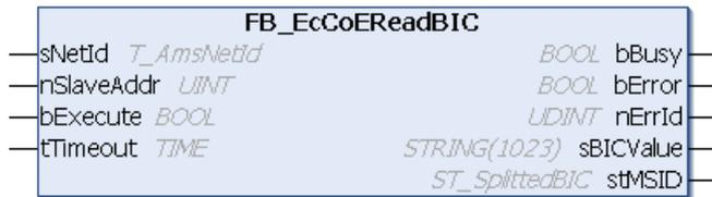
Mit dem Funktionsbaustein FB\_EcCoeReadBIC kann per SDO(Service Daten Objekt)-Zugriff die BIC aus dem Objektverzeichnis eines EtherCAT-Slaves ausgelesen werden. Dazu muss der Slave eine Mailbox besitzen und das "CANopen over EtherCAT (CoE)"-Protokoll unterstützen und das Objektverzeichnis muss ein Objekt 0x10E2:01 mit der BIC enthalten.
