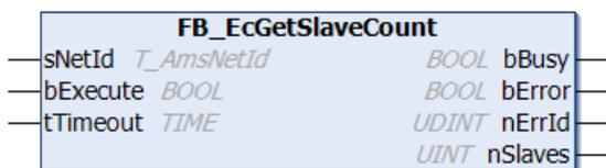
Mit dem Funktionsbaustein `FB_EcGetSlaveCount` kann die Anzahl der Slaves, die an den Master angeschlossen sind, ermittelt werden.
