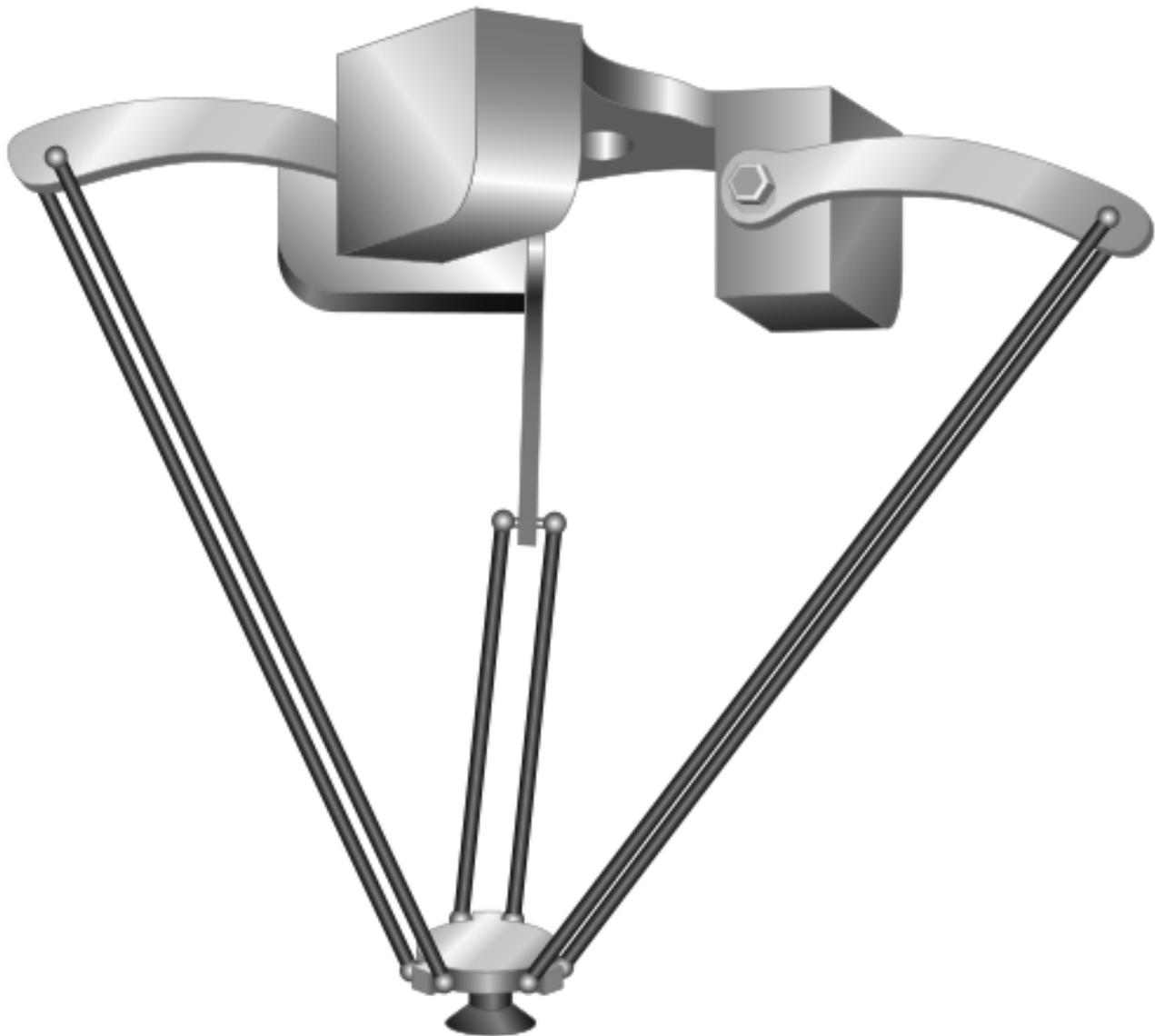
Abb. 127: Hängende Delta-Roboter-Kinematik
