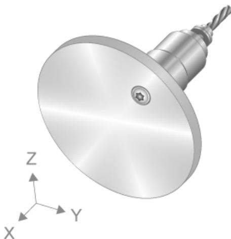
Abb. 115: Exzentrerscheiben-Kinematik mit Drehung um X
