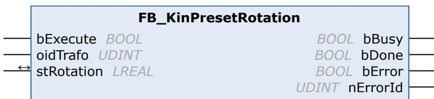
Mit dem Funktionsblock FB\_KinPresetRotation wird der Rotationszustand gesetzt.
