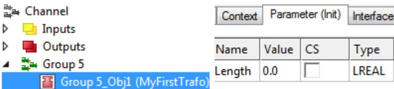
⇒ Die Transformation kann jetzt von der SPS aus aktiviert werden (siehe [SPS-Bibliothek](#) [► 78]). Definieren Sie zum Ansprechen der Transformation ein zyklisches Kanalinterface in der SPS und verknüpfen Sie dieses mit den IO des Kinematikkanals.
