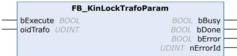
Nachdem die Transformationsparameter mit Hilfe von [FB\\_KinUnlockTrafoParam](#) [► 88] verändert wurden, sperrt der Funktionsbaustein FB\_KinLockTrafoParam erneut die Transformationsparameter, so dass diese nicht mehr beschrieben werden können.
