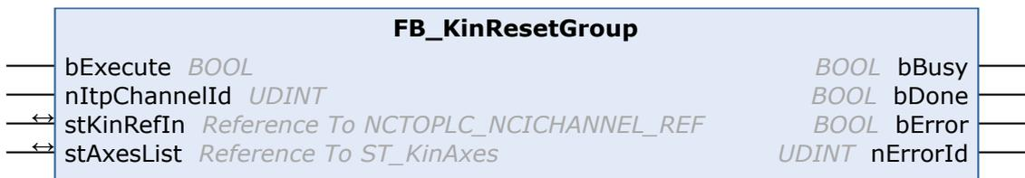
Mit dem Funktionsbaustein FB\_KinResetGroup wird die Kinematikgruppe zurückgesetzt. Alle ACS- und MCS-Achsen werden zurückgesetzt. Des Weiteren kann der Eingang *nItpChannelId* für die Festlegung des zugehörigen Interpolationskanals verwendet werden. Der Kanal wird zurückgesetzt, wenn die *nItpChannelId* ungleich 0 ist.
