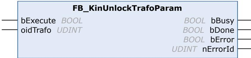
Mit dem Funktionsbaustein FB\_KinUnlockTrafoParam werden Transformationsparameter entsperrt, die einen Einfluss auf die Position haben, so dass diese geschrieben werden können.
