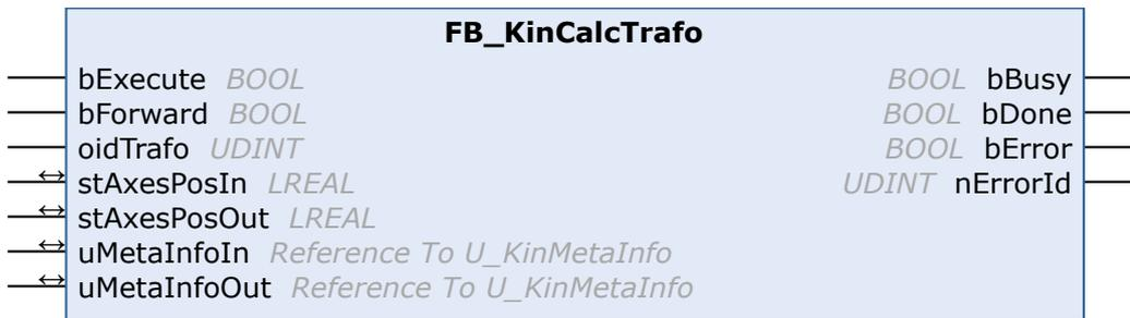
Mit dem Funktionsbaustein FB\_KinCalcTrafo wird die Vorwärts- oder Rückwärtstransformation berechnet, selbst dann, wenn keine Kinematikgruppe mit FB\_KinConfigGroup [▶ 79] erstellt wurde.
