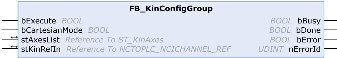
Mit dem Funktionsbaustein FB\_KinConfigGroup werden Achsen entsprechend der kinematischen Transformation konfiguriert. Diese sind Achsen für das ACS (Gelenk) und das MCS (kartesisch). Der Funktionsbaustein nimmt die in der **stAxesList** definierten ACS- und MCS-Achsen und konfiguriert sie in der Kinematikgruppe von **stKinRefIn**.
