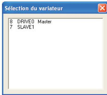
Les modules maître et d'axe reconnus par le système sont représentés avec leur adresse de station et leur nom. Le module maître est signalisé. Double-cliquez sur l'amplificateur que vous souhaitez mettre en service. Par la suite, vous pourrez ajouter un module d'axe, l'afficher à l'écran et le paramétrer (fonction multi-variateur).
