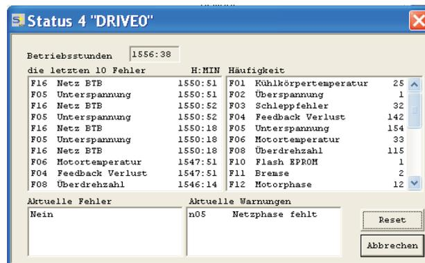
Die Reset Schaltfläche kann verwendet werden, um einige Fehler zurückzusetzen. Eine Beschreibung der Fehler-/Warnmeldungen finden Sie auf Seite 88.
