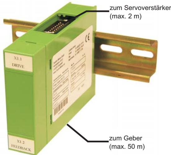
Die erweiterte Spannungsversorgung ermöglicht es, Gebersysteme an Stecker X1 mit einer Stromaufnahme von bis zu 400 mA DC zu betreiben. Diese Spannungsversorgung wird zwischen X1 und den Geber geschaltet und vom AX2000 versorgt.
