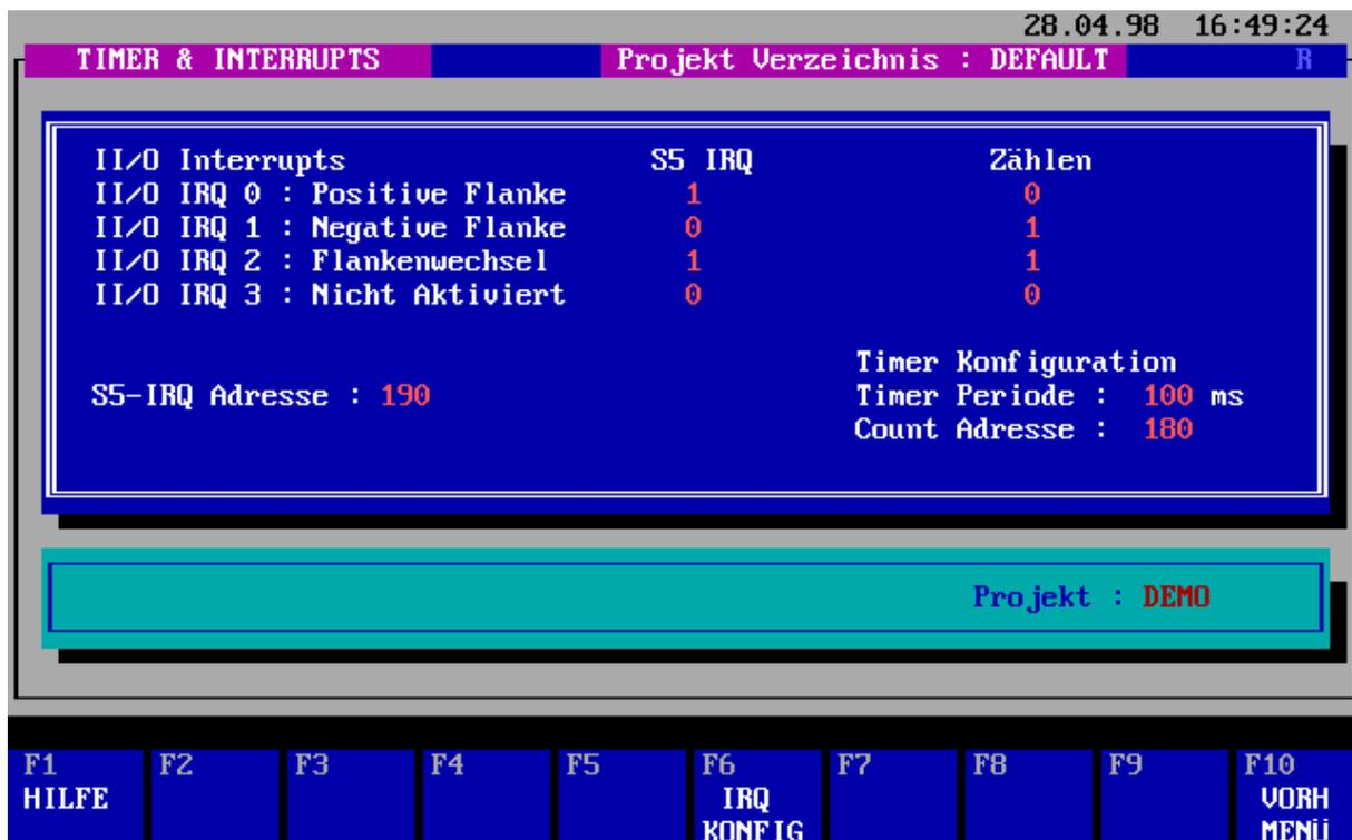
Die schnellen Interrupts werden konfiguriert indem der Cursor auf das entsprechende Interruptfeld gesetzt wird und mit der Funktionstaste F6 die entsprechende Charakteristik ausgewählt wird. Durch Betätigen der Taste F6 kann zwischen 'Nicht Aktiviert', 'Positive Flanke', 'Negative Flanke' und 'Flankenwechsel' ausgewählt werden.
