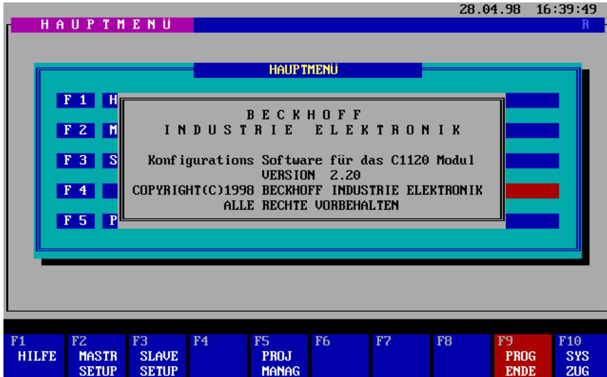
Generell werden alle Funktionen über die Funktionstasten F1 - F10 ausgelöst. Einige Funktionen sind über eine zusätzliche Abfrage gesichert. Soll die Funktion ausgeführt werden, ist diese Abfrage mit 'J' oder 'Y' zu quittieren, soll die Funktion abgebrochen werden mit 'N' oder ESC. Mit der Taste ESC gelangen Sie zusätzlich in die nächst höhere Menüebene.
