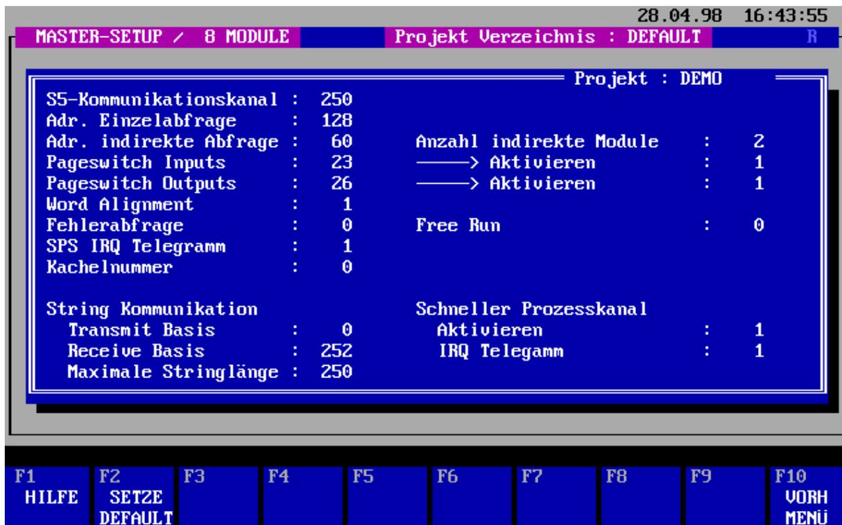
Das Feld **S5 Kommunikationskanal** legt die Basisadresse für die Parallelkanalfunktionen (siehe auch Kapitel 'Parallelkanal') fest. Beim Einsatz mehrerer C1120 Baugruppen kann der Kommunikationskanal von der Defaulteinstellung 250 auf einen anderen Adreßbereich verlegt werden (Einstellbereich 128 - 250, Länge 6 Byte). Mit geänderter Einstellung werden ebenfalls die Adressen der Statusregister auf Eingabewert +4 und die Interruptauslösung auf Eingabewert +5 verändert.
