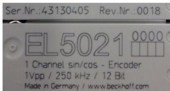
図 1: シリアル/バッチ番号、およびリビジョンIDが記載されたEL5021 ELターミナル、標準IP20 I/Oデバイス (2014年1月以降の印字)
