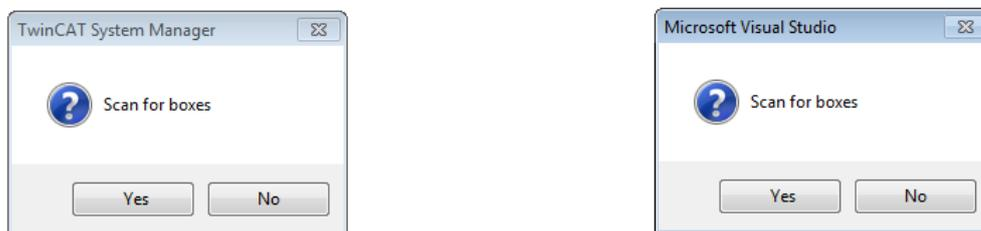
図 95: EtherCATデバイスの自動作成後のスキャン開始確認ダイアログ(左: TwinCAT 2、右: TwinCAT 3)
