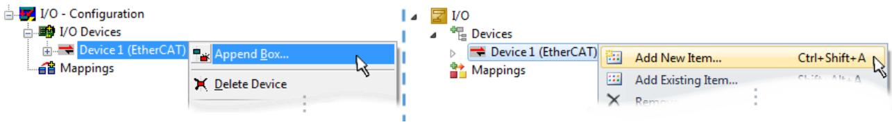
図 82: EtherCATデバイスの追加(左: TwinCAT 2、右: TwinCAT 3)
