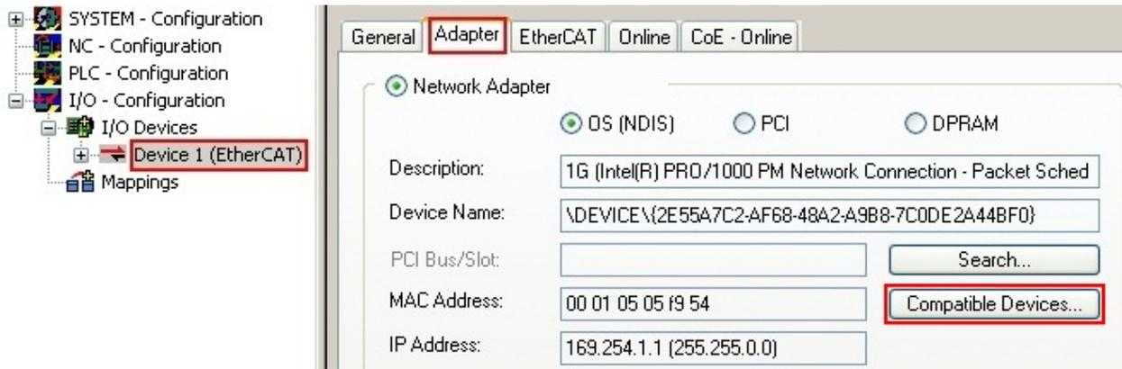
図 65: EtherCATデバイスのプロパティ (TwinCAT 2): タブ[Adapter]の[Compatible Devices]をクリック
