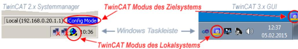
Abb. 99: Unterscheidung Lokalsystem/ Zielsystem (links: TwinCAT 2; rechts: TwinCAT 3)
