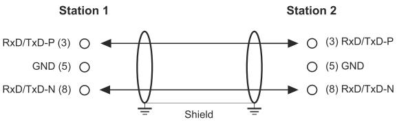
Fig. 13: PROFIBUS cabling
