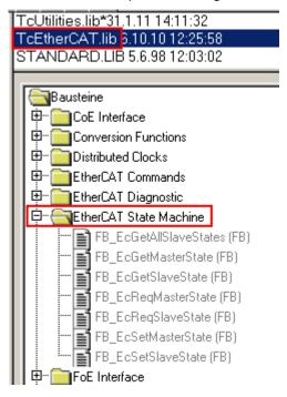
Fig. 81: PLC function blocks
