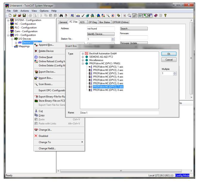
Fig. 101: Inserting a box
