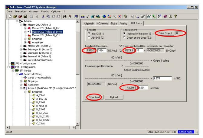
Fig. 109: PROFIdrive tab, reading motor parameters
