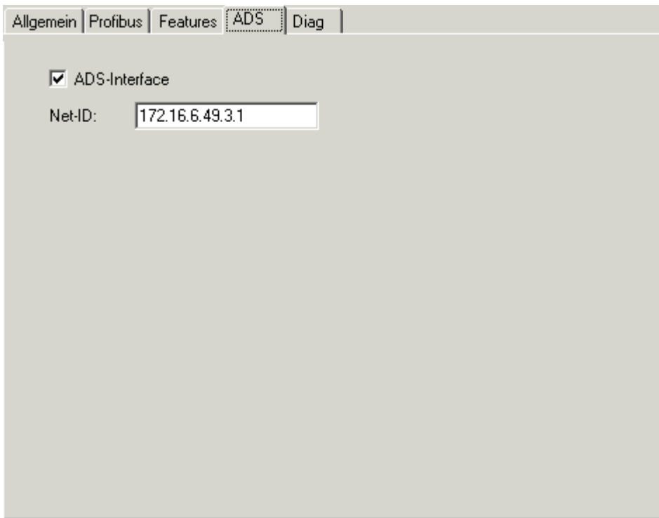
Abb. 124: DP-Master Karteireiter ADS: Aktivieren des ADS-Interface und Eintragen der Net-ID
