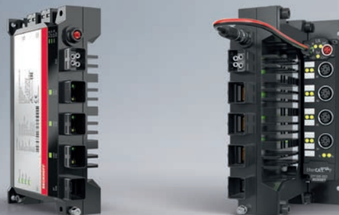
C7015 超紧凑型工业 PC, 可连接防护等级为 IP 67 的 EtherCAT P 端子盒
