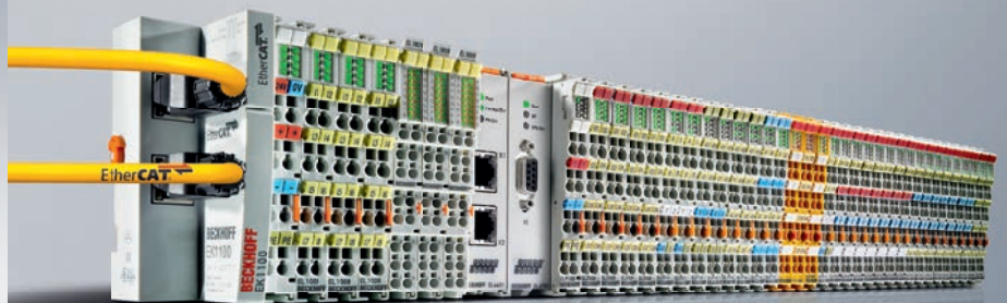
EtherCAT I/O: 防护等级为 IP 20 和 IP 67 的全系列 I/O 产品
