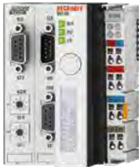
バスターミナルコントローラBXシリーズ (IEC 61131-3 PLCと拡張インターフェースを内蔵)
