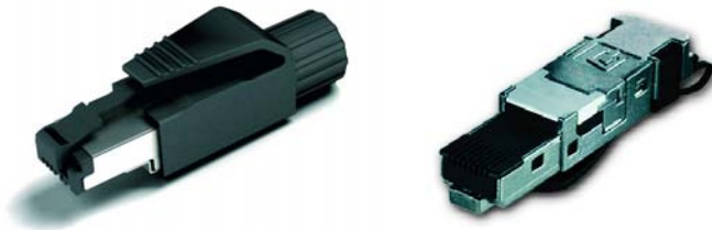
Abbildung 4-6: Steckverbinder nach EN60603-7, feldkonfektionierbar, links: vierpolig, Fast-Ethernet-kompatibel*, rechts: achtpolig, geeignet für Gigabit-Ethernet
