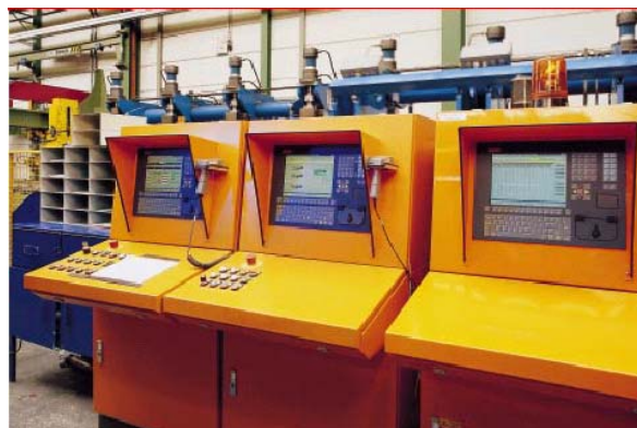
Центральная операторская станция для управления оборудованием гибки, распиловки и штамповки. На каждом технологическом участке для решения задач управления, визуализации и связи используется отдельный промышленный ПК.
